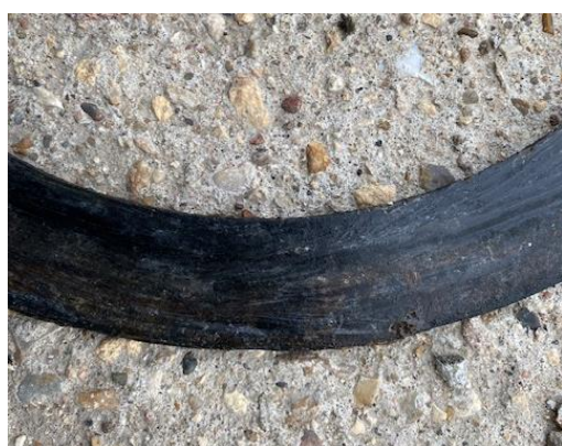
Рисунок 4.3 – Фотографии следов износа на поверхности уплотнения [110]
