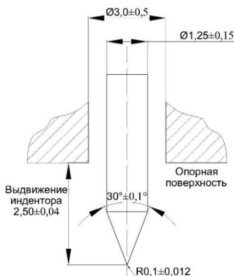
Рисунок 3.3 – Чертеж индентора для дюрометра типа D
