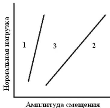
Рисунок 1.10 – Типичная карта механизмов фреттинг-изнашивания: 1 – область сцепления; 2 – область существенного проскальзывания; 3 – область частичного проскальзывания [66]
