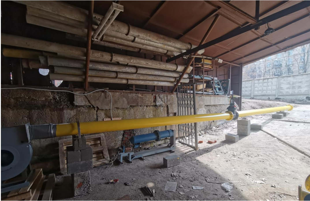
Рисунок 2.6 – Схема (а) и фотография (б) стенда: 1 – вентилятор, 2 – участки трубопровода, 3 – задвижка, 4 – фланцевые соединения
