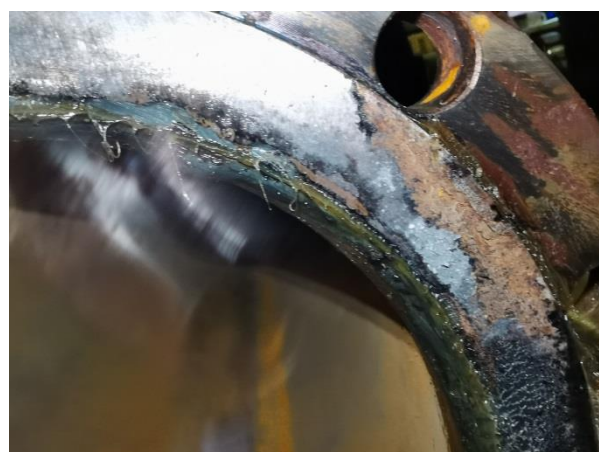
Рисунок 4.2 – Фотографии уплотнительных поверхностей фланцев со слоем порошкообразных продуктов изнашивания [110]
