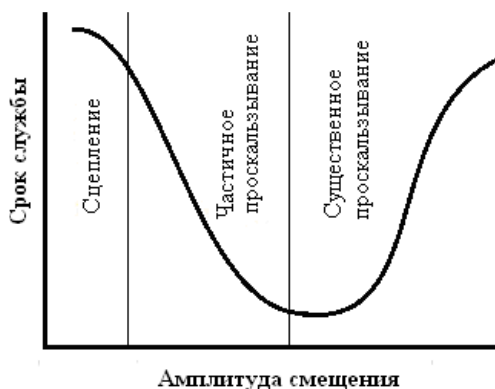
Рисунок 1.11 – Схематическое изображение зависимости срока службы контактного соединения от амплитуды тангенциального смещения [67]
