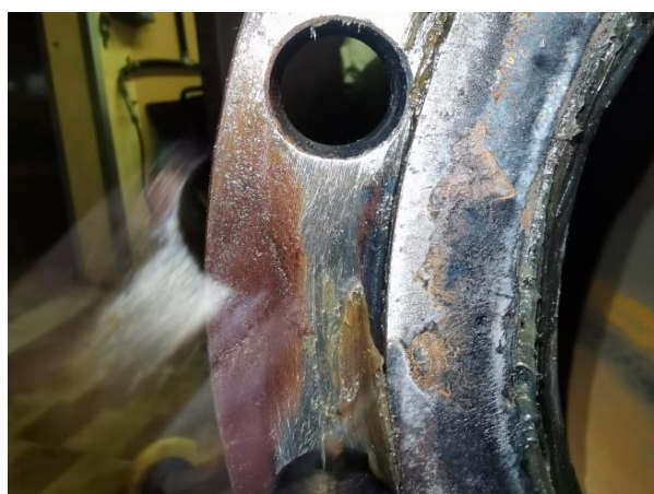
Рисунок 4.2 – Фотографии уплотнительных поверхностей фланцев со слоем порошкообразных продуктов изнашивания [110]
