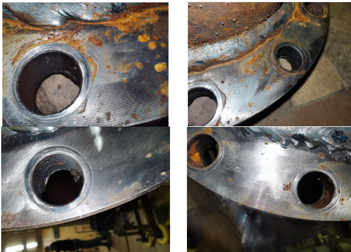
Рисунок 4.4 – Фотографии следов износа на наружных поверхностях фланцев в местах крепления болтовыми соединениями [110]
