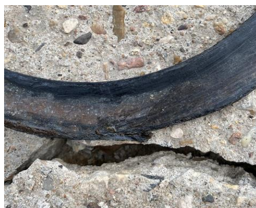
Рисунок 4.3 – Фотографии следов износа на поверхности уплотнения [110]
