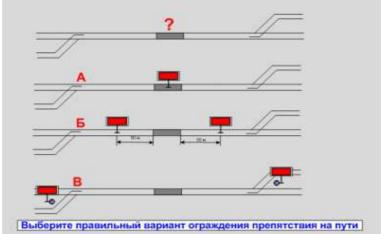
**11 Вопрос:** Однопутный перегон. Выберите правильный вариант осигналивания одиночного локомотива ночью при следовании в направлении, указанном стрелкой».
