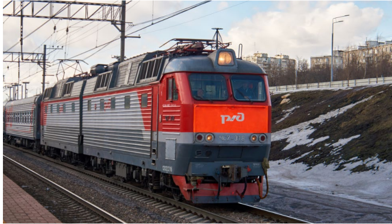
Рисунок 1.11 – Электровоз постоянного тока ЧС7 (осевая формула 2(2о-2о))
