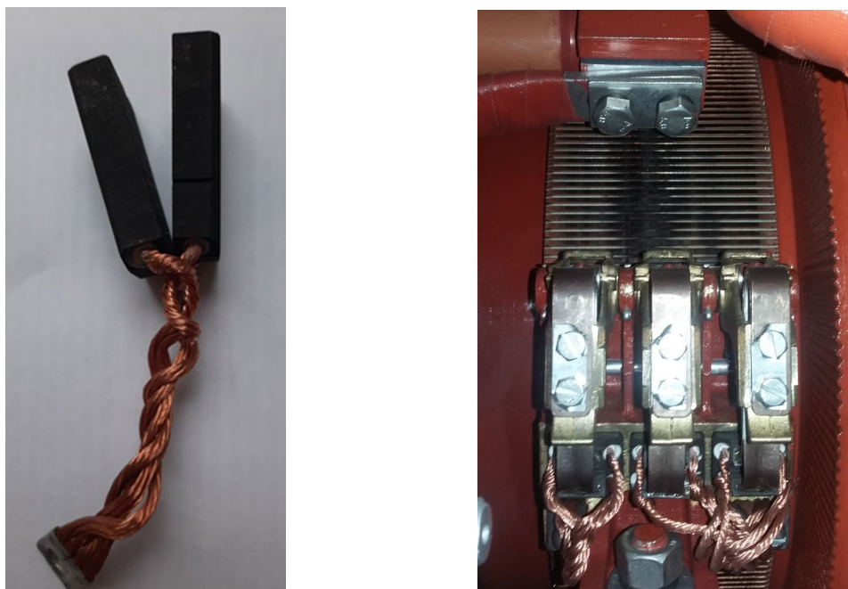
Рисунок 1.16 – Щётка ЭГ-61А (слева); скользящий контакт «щетка – коллектор» (справа), видно почернение поверхности коллектора вследствие переброса
