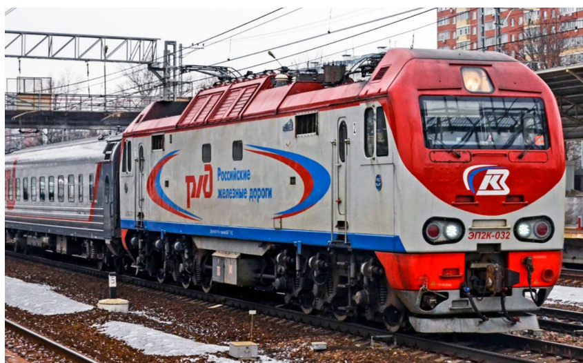
Рисунок 1.9 – Электровоз постоянного тока ЭП2К (осевая формула 3о – 3о)
