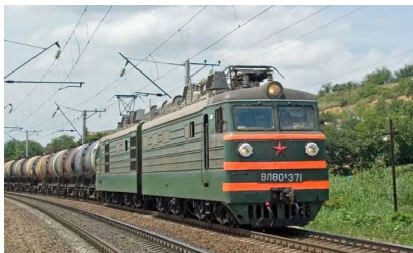
Рисунок 1.5 – Электровоз переменного тока ВЛ80к (осевая формула 2(2о – 2о))
