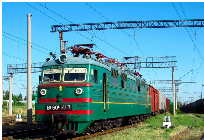
Рисунок 1.4 – Электровоз переменного тока ВЛ60к (осевая формула 3о – 3о)
