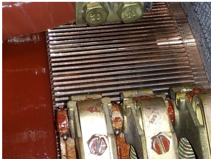
Рисунок 5.5 – Поверхность коллектора ТЭД после испытаний
