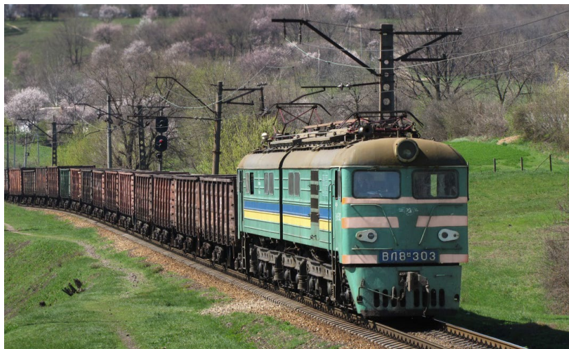
Рисунок 1.3 – Электровоз постоянного тока ВЛ8 (осевая формула 2_0+2_0+2_0+2_0 )
