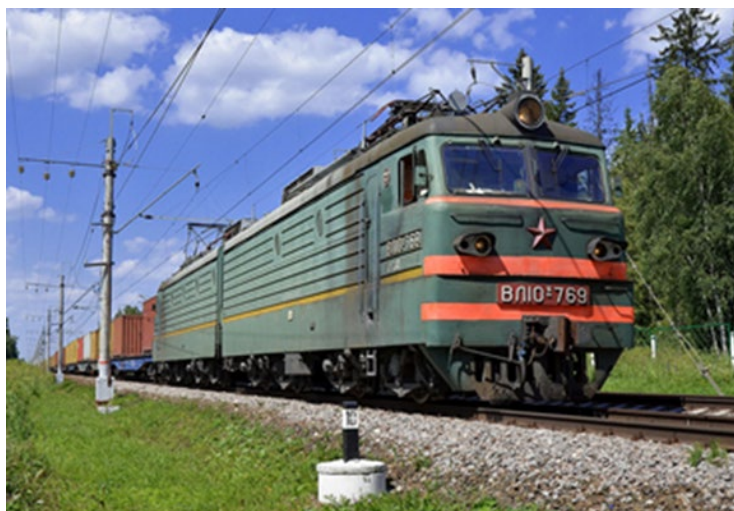
Рисунок 1.6 – Электровоз постоянного тока ВЛ10 (осевая формула 2(2о – 2о))
