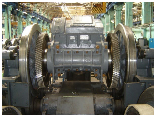
Рисунок 2.13 – Тяговый двигатель НБ-514Е (слева) и колесно-моторный блок с подшипниками качения (справа)
