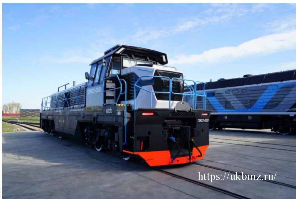
Рисунок 191 – Двухдизельный тепловоз ТЭМ23 с асинхронным тяговым приводом
