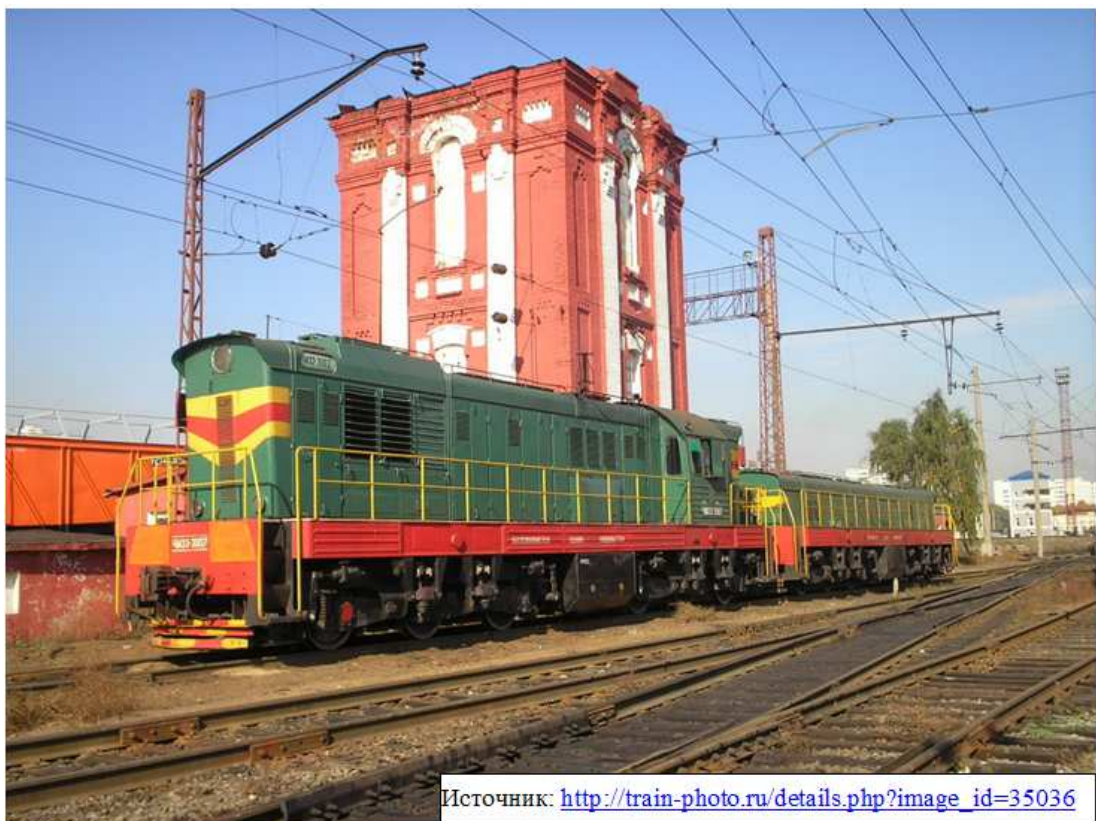
Рисунок 1 – Тепловоз ЧМЭЗ с бустером ЧМЭЗБ
