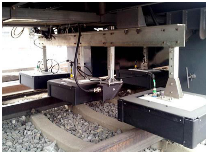
Рисунок 4.4 – Программно-аппаратный комплекс SafeRailSystem (SRS) (Италия), размещенный на подвижной единице, используемой на сети железных дорог Казахстана
