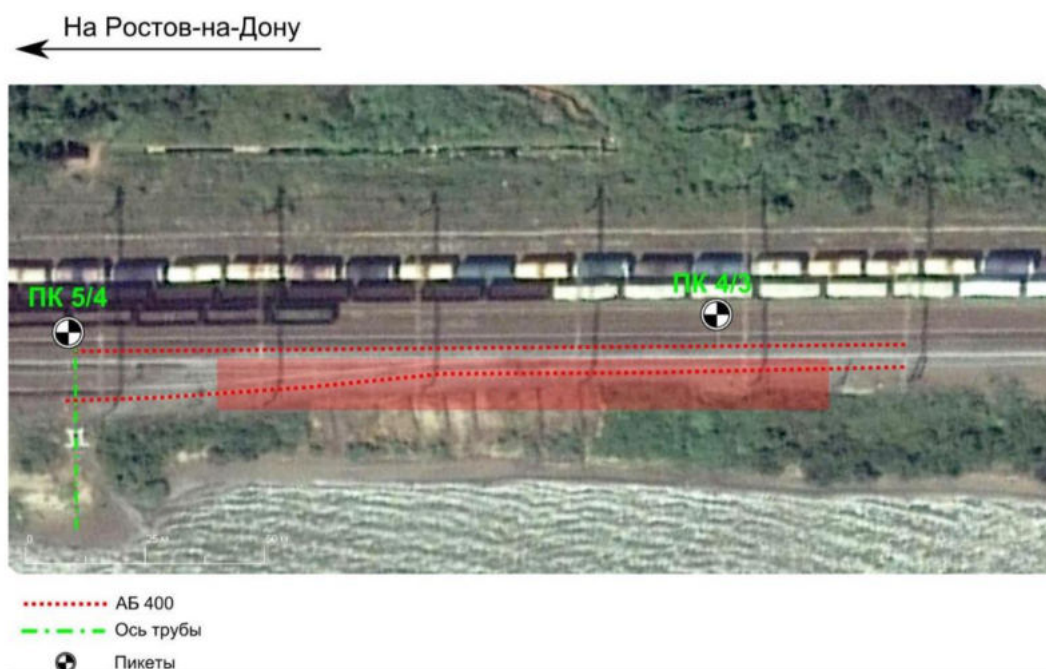
Рисунок 5.22 – Схема проведения георадиолокационной диагностики
