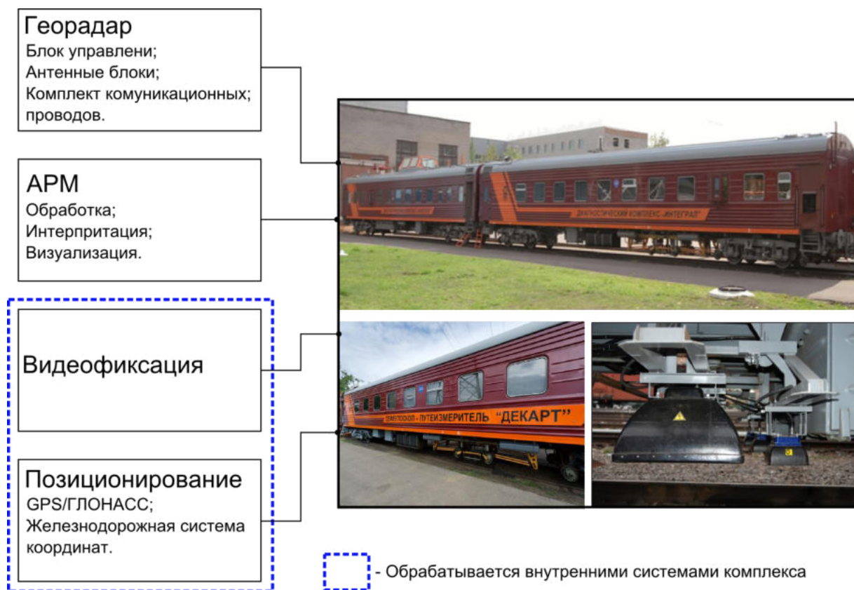
Рисунок 4.2 – Программно-аппаратный комплекс, размещенный на подвижной единице
