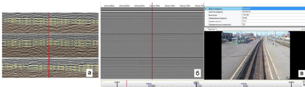
Рисунок 4.9 – Информация, выводимая на экран монитора оператора при использовании в режиме реального времени: обработанная (а), зарегистрированная (б) георадиолокационная информация и (в) видеоинформация
