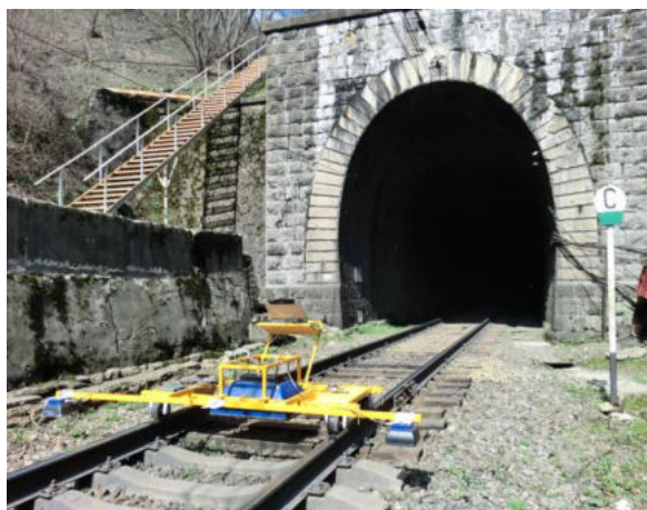
Рисунок 3.54 – Геодефектоскоп для обследования балластного слоя
