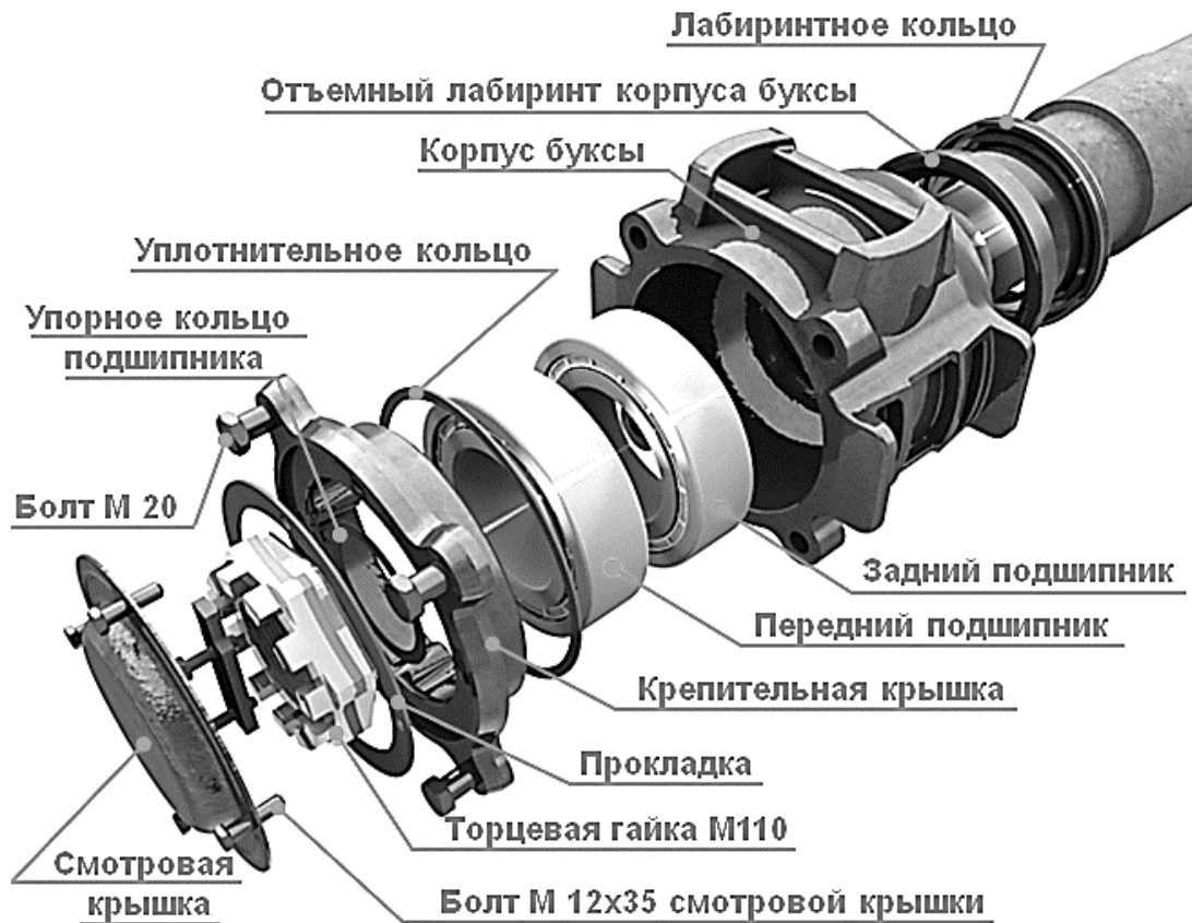
Рисунок 5.2 – Устройство буксового узла с роликовыми подшипниками
