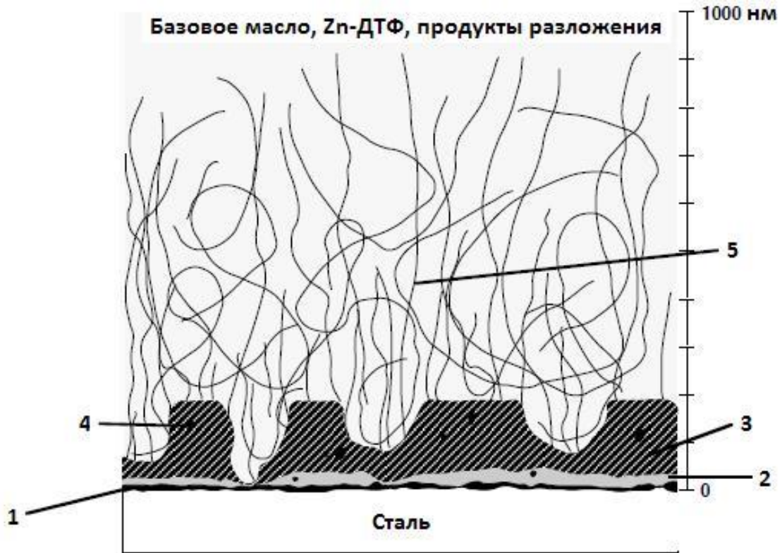
Рисунок 1.2 – Схематическое представление структуры граничного слоя, формируемого Zn-ДТФ при трении [42]:
