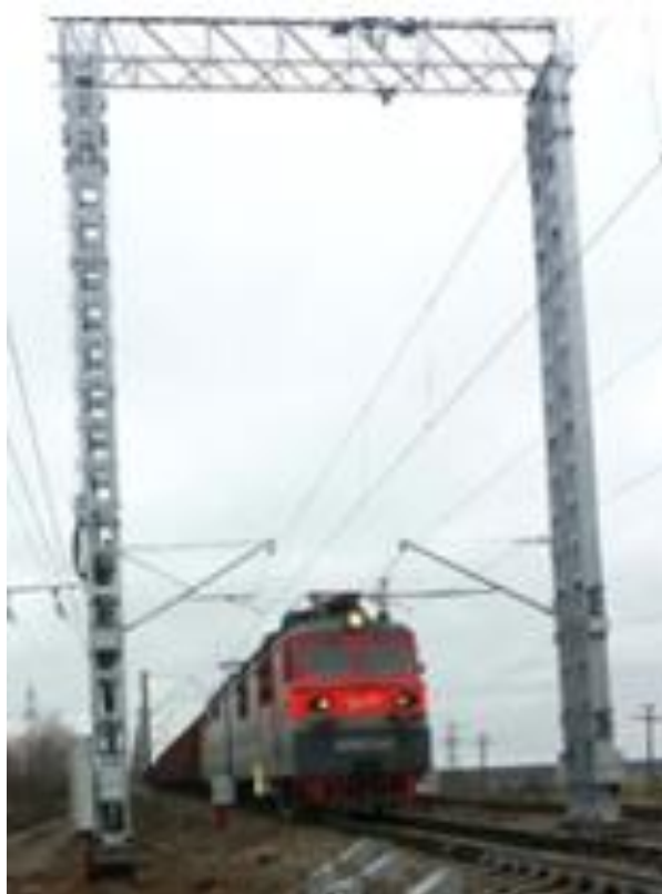
Рисунок 4.7 - Интегрированный пост автоматизированного приёма и диагностики подвижного состава на сортировочных станциях
