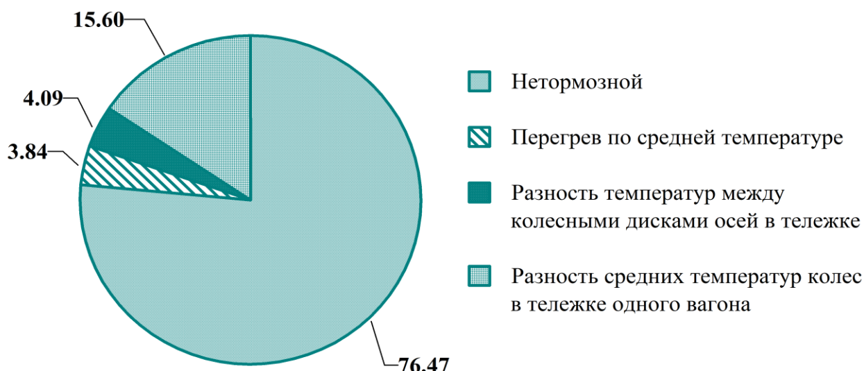
Рисунок 4.6 – Диаграмма распределения неисправностей тормозного оборудования, выявленных комплексом «АСТЕКО-01» [143]
