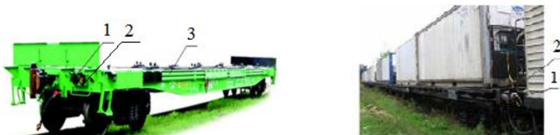
Рисунок 5.5 – Порядок размещения КРК и общий вид дооборудованных платформ: 1 – розетка для подключения рефрижераторного контейнера; 2 – розетка для подачи напряжения в низковольтную магистраль; 3 – низковольтная магистраль для передачи электрической энергии
