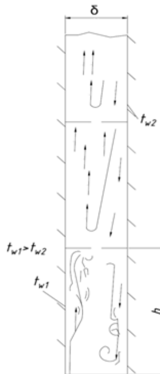
Рисунок 4.1 – Схема движения токов воздуха между стеной ГП и штабелем груза
