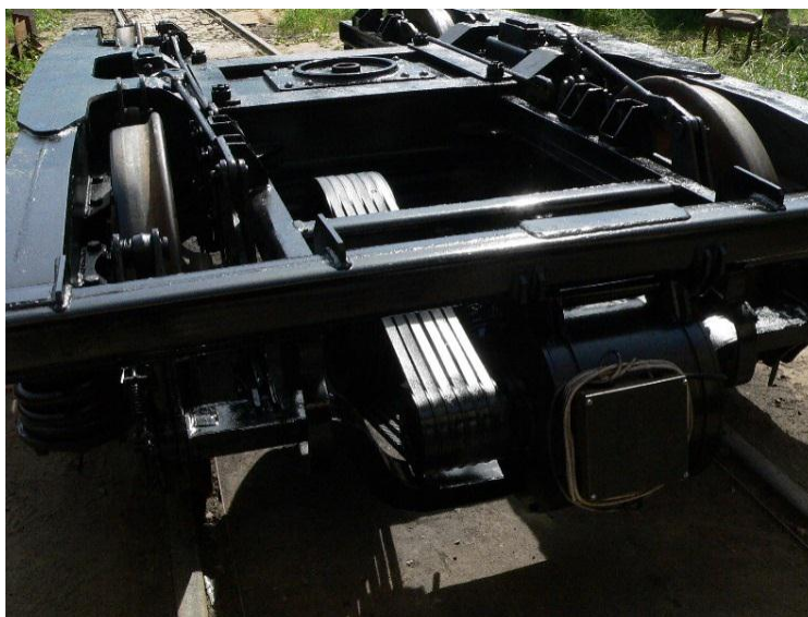
Рисунок 7.28 – Подвеска генератора на тележке КВЗ-И2 (Тележка может комплектоваться круговыми и разъемными (с соединительными элементами) текстропными ремнями производства Дании)
