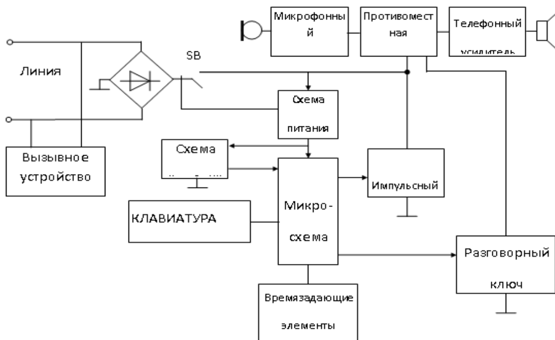
Рисунок 1.3 – Структурная схема электронных ТА вариант 1
