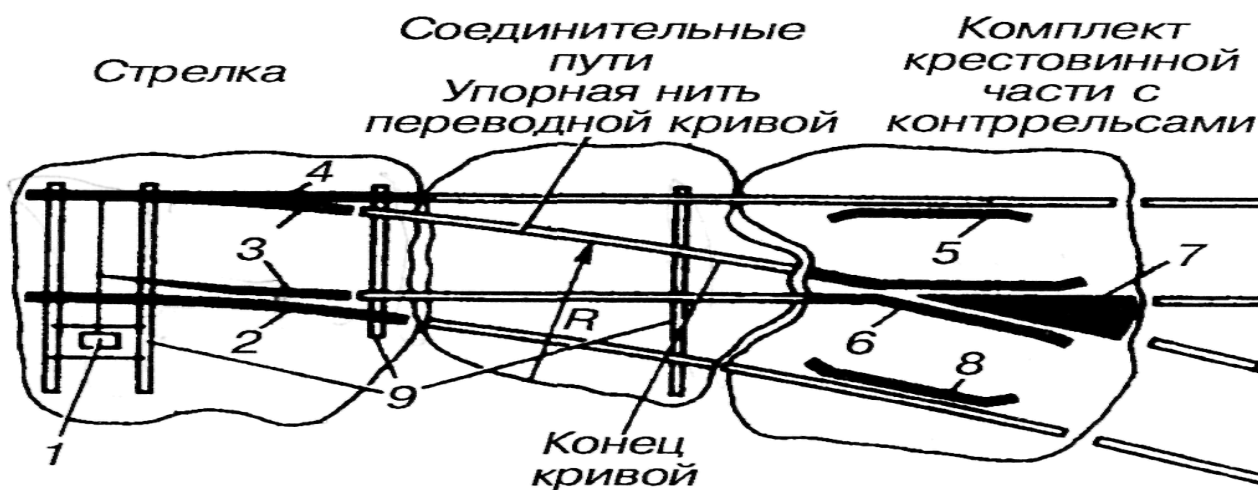
Рис. 8. Схема обыкновенного стрелочного перевода:
