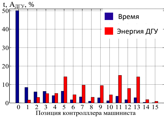
Рисунок 3 – Распределение времени работы и энергии, выработанной ДГУ
