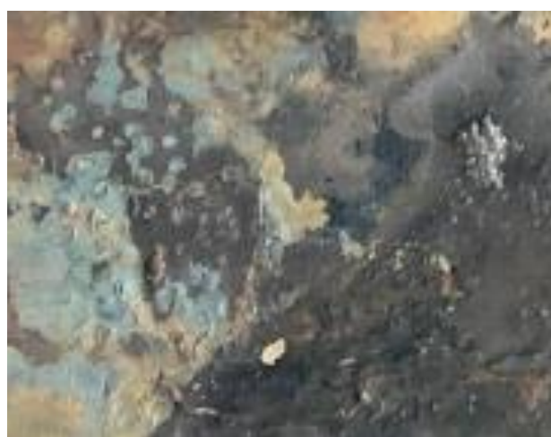
Рисунок 20 - Фотографии поверхности образцов из стали 20А и 09Г2С после выдержки: а) рН 8,0, S=0 г/л, T=+20 0С, б) рН 8,0, S=10 г/л, T=+80 0С
