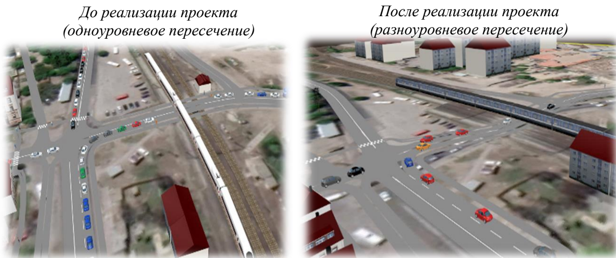
Рисунок 8 – Имитационная модель железнодорожно-автомобильного пересечения в программе PTV Vissim
