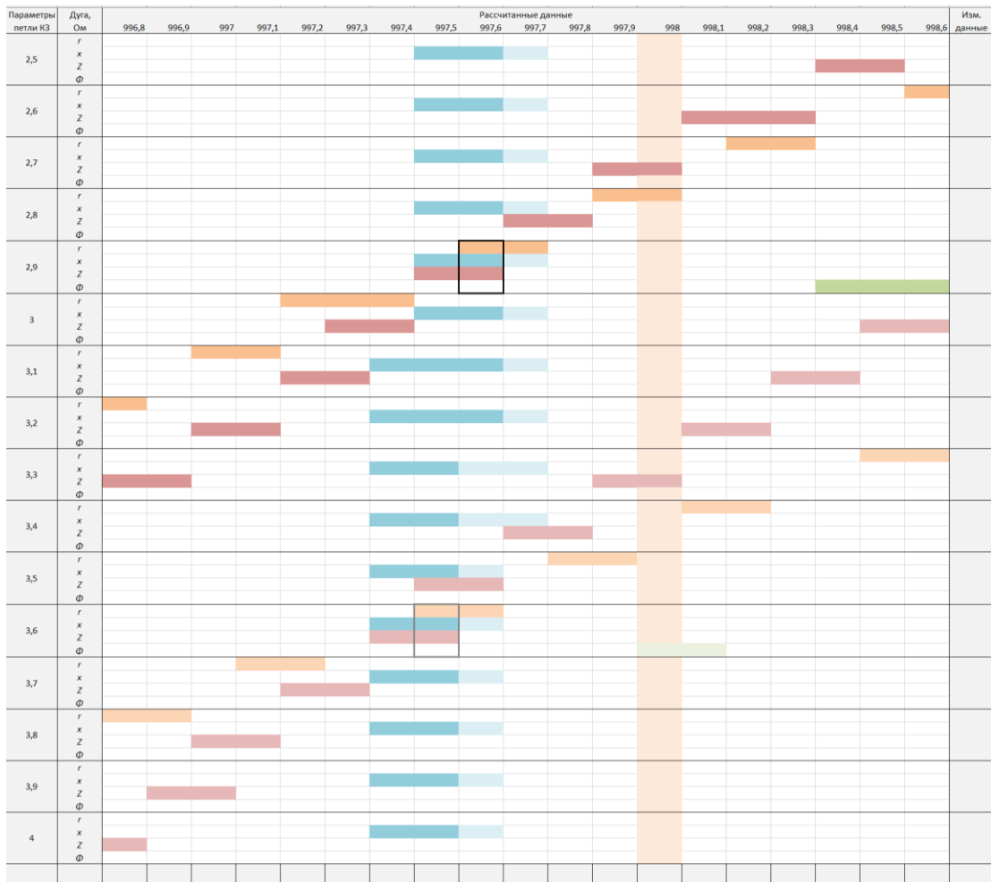
Рисунок 4.17 – Фрагмент матрицы, показывающий погрешность в определении места КЗ с учетом фактора сопротивления внешних сетей при КЗ на 998 км
