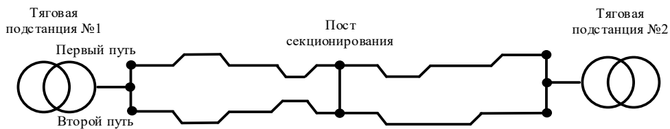
Рисунок 1.8 – Эквивалентированная схема участка с переменной шириной междупутья
