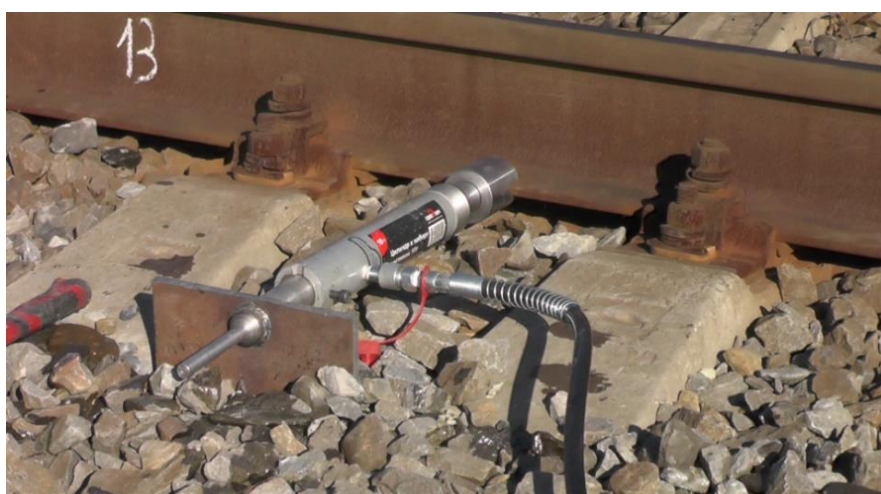
Рисунок 2.2 – Измерения усилия сдвига плеча балластной призмы с помощью прибора ИСС-1
