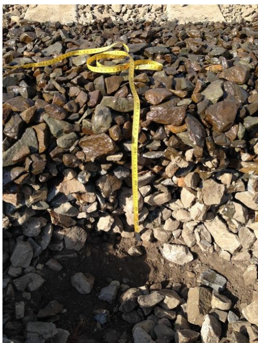
Рисунок 3.4 – Определение толщины геокомпозита шурфлением балластной призмы
