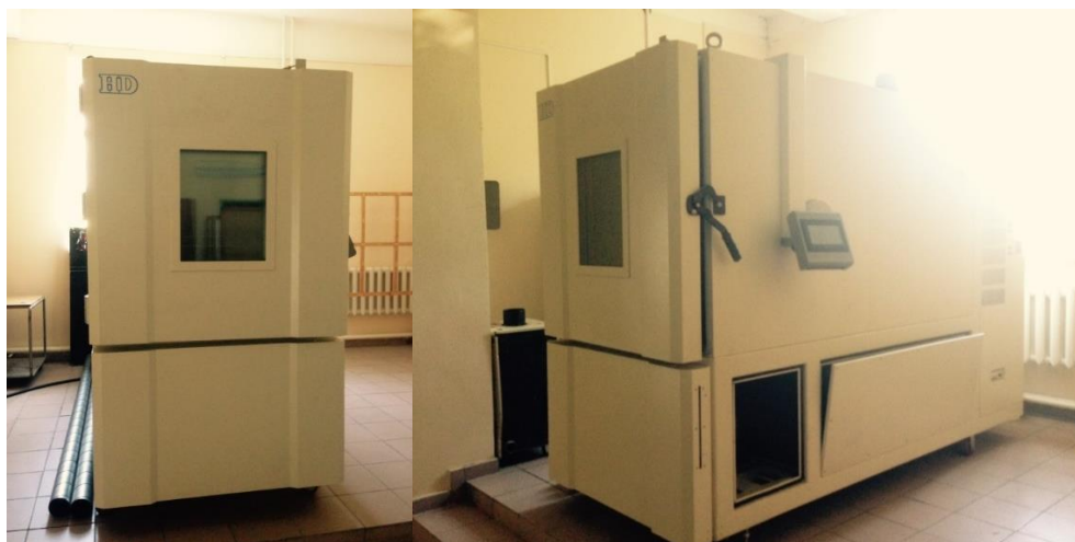
Рисунок 2.12 – Технологический участок с установленной испытательной климатической камерой модели HD KWGDS62IF фирмы Hyde Science and Technology Limited. Научно-исследовательский и испытательный центр «Криотрансэнерго» (НИИЦ КТЭ ФГБОУ ВО РГУПС)
