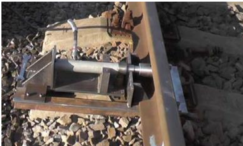
Рисунок 2.4 – Размещение прибора ИСС-2 при измерении сопротивления сдвигу шпалы
