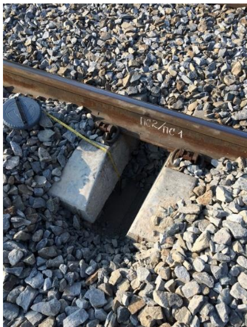
Рисунок 4.5 – Определение толщины балластного слоя железнодорожного пути
