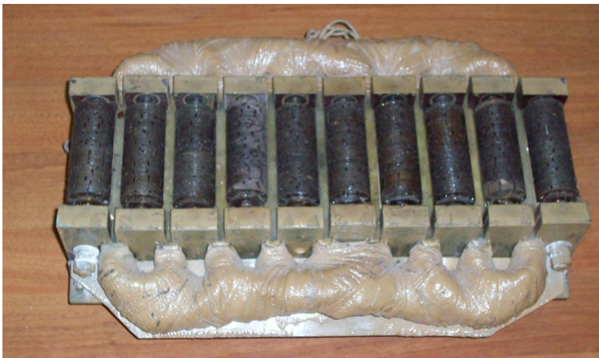
Рис. 9.2 – Макетный образец ЛАД для МЛТ и дополнительных тяговых и тормозных устройств высокоскоростных поездов
