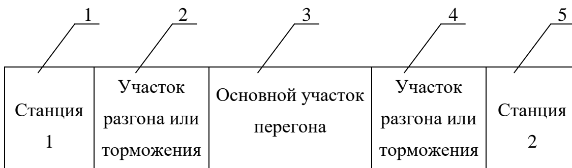
Рис. 1.1. Путевая структура перегона МЛТ
