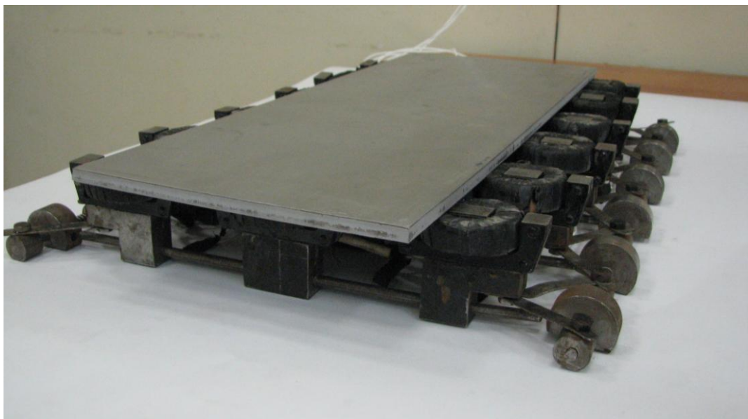
Рис. 9.1 – Лабораторная модель ЛАД, развивающая усилия поперечной самостабилизации
