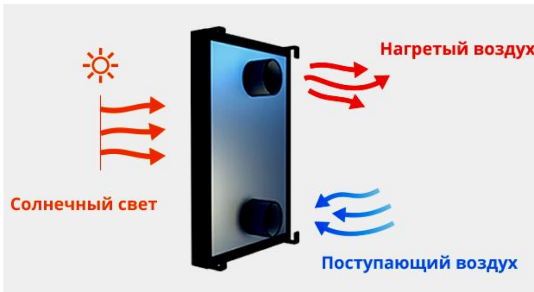
Рис.2.7 – Общий вид воздушного коллектора
