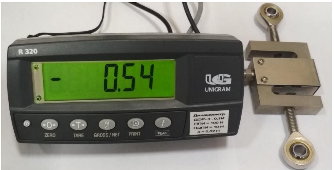
Рисунок 3.7 Индикатором R320 и тензометрический S-образный датчик
