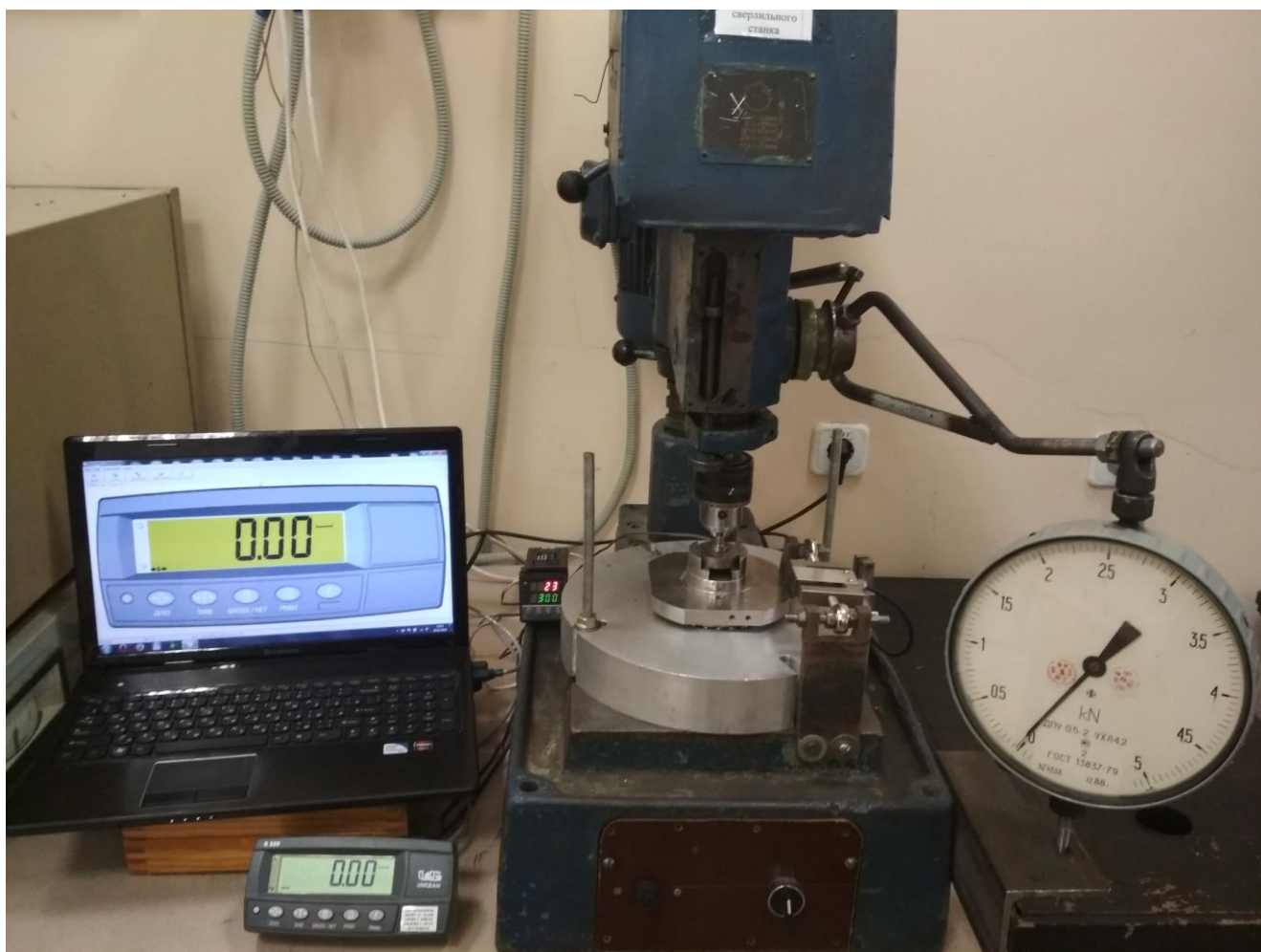
Рисунок 3.8 Стенд для триботехнических исследований
