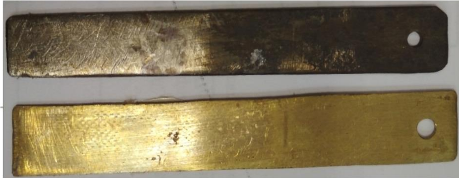
Рис.3.12 Пластины для исследования адгезионной прочности
