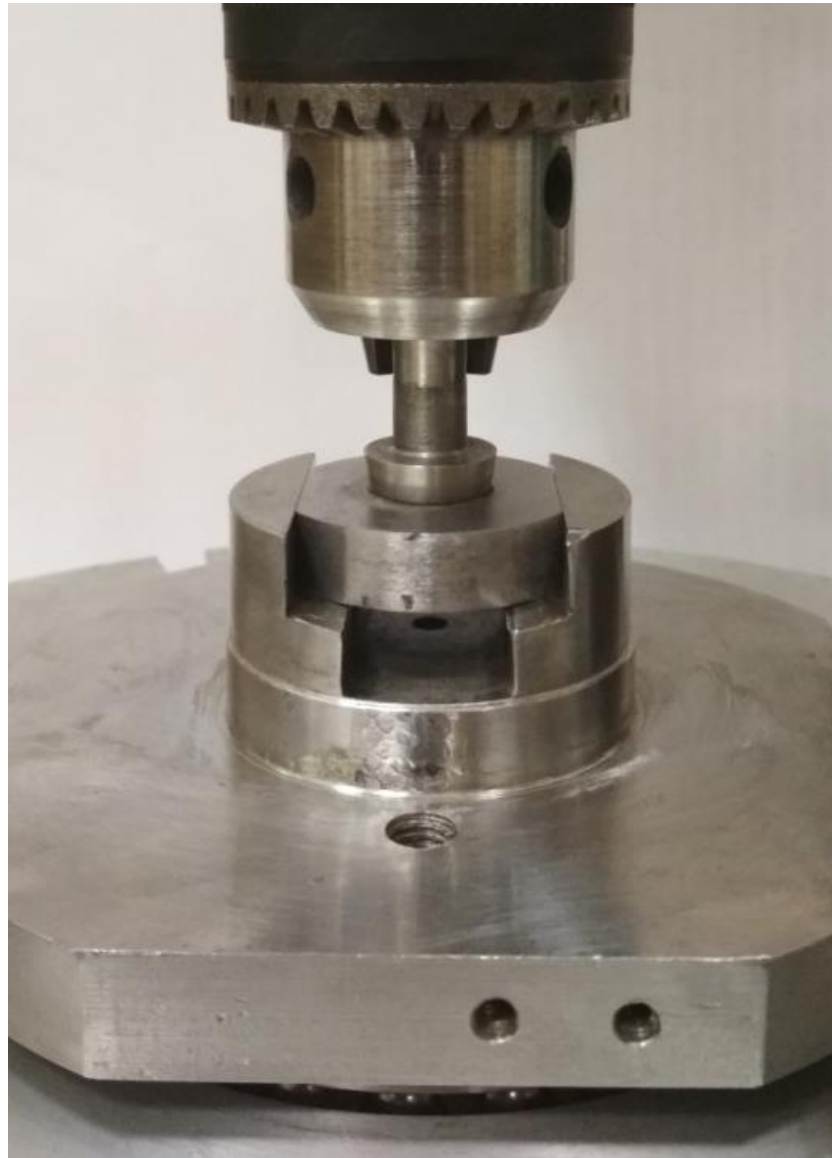
Рисунок 3.6 Приспособление для фиксации образцов
