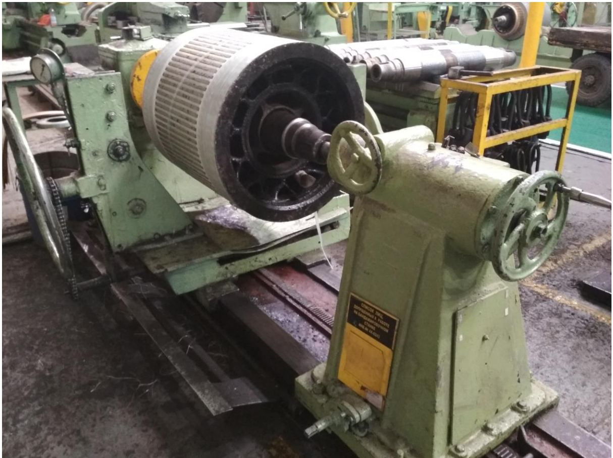
Рисунок 5.1 Общий вид бандажировочного станка А591
