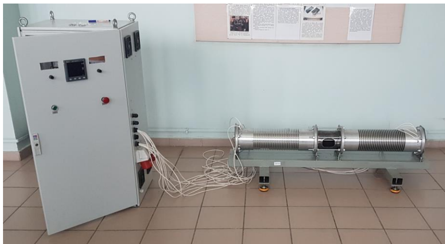
Рисунок 5.6 – Высокооборотный электрогенератор и АИН
