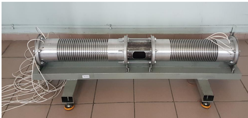
Рисунок 5.7 – Бесколлекторные электрические машины в составе испытательного стенда
