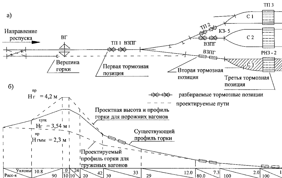
Рис. 56. План и профиль северного совмещенного горочного комплекса станции «Б»: а – план головы сортировочного парка; б - продольные профили совмещенных горок
