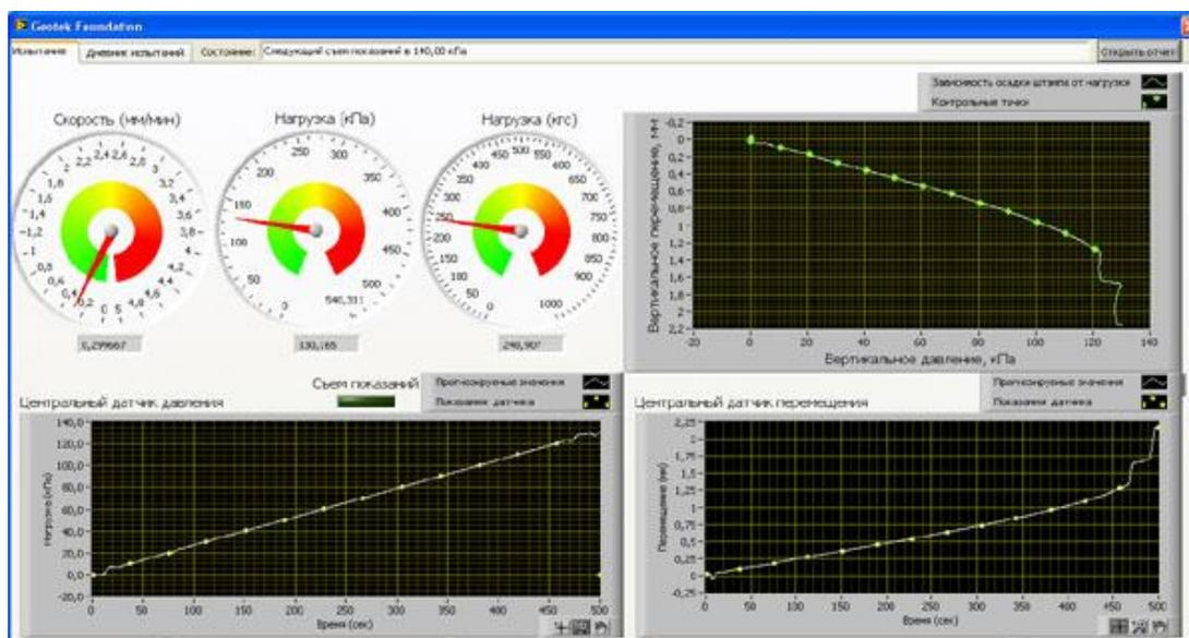
**Рис. 1.3. Окно программы Geotek-Foundation: процесс испытания**
