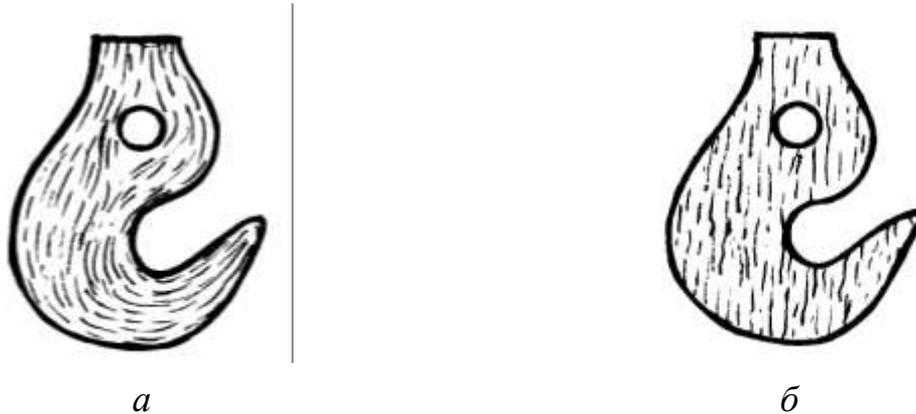
Рис. 4. Схема макроструктуры с правильным (а) и неправильным (б) расположением волокон в стали
