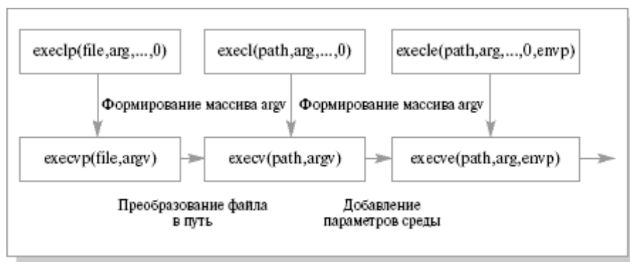
Рисунок 4 – Взаимосвязь различных функций для выполнения системного вызова exec()
