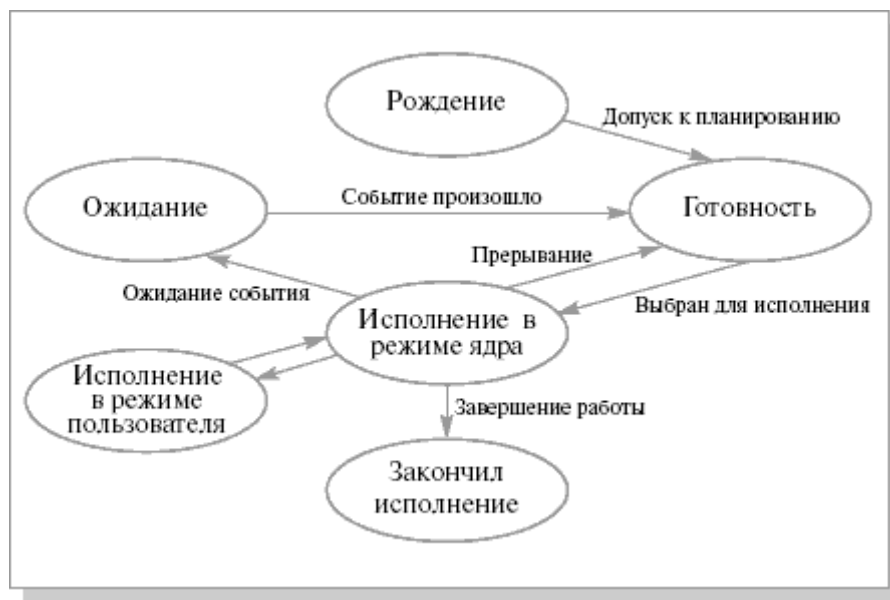
Рисунок 3 – Сокращенная диаграмма состояний процесса в LINUX
