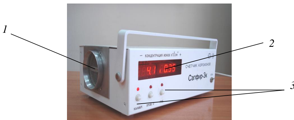
Рис. 6. Счетчик аэроионов «Сапфир-3к»: 1 – входное отверстие; 2 – дисплей; 3 – панель управления
