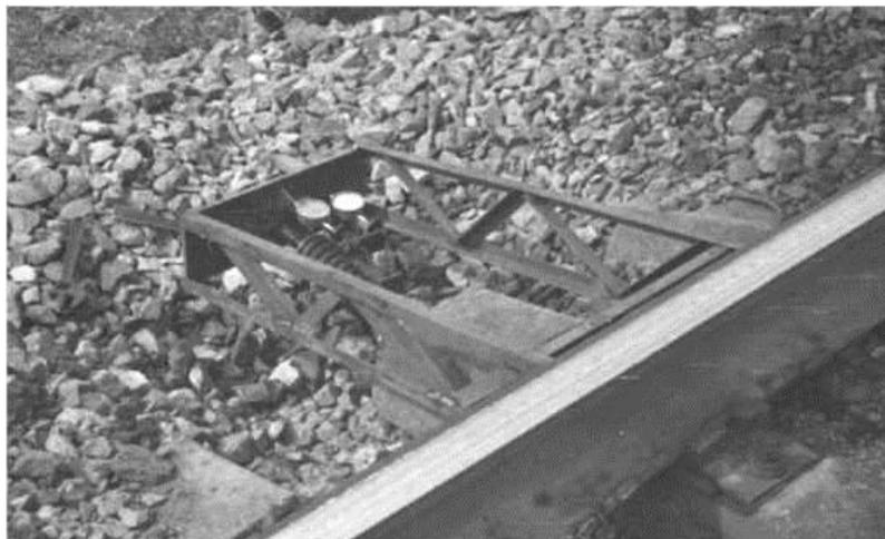
Рисунок 2.5. Рама с пружинно-винтовым прибором [65, 66, 95]
