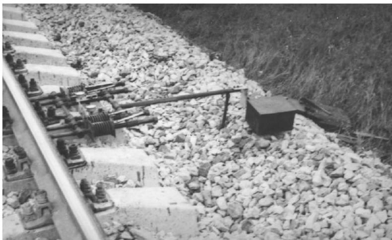
Рисунок 2.4. Пружинно-винтовой прибор В.В. Ершова [2]
