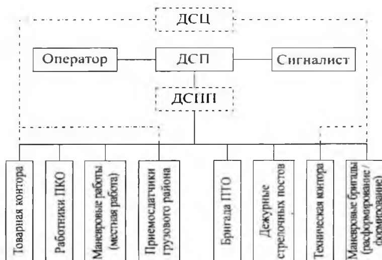
Рис. 1. Схема оперативного управления участковой ж/д станцией
