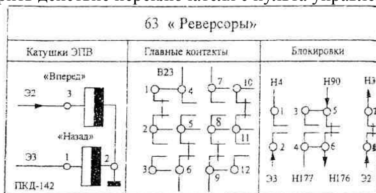
Рисунок 4.2 – Расположение главных и вспомогательных контактов в положении «вперед», «назад» и диаграмма замыкания контакторных элементов
