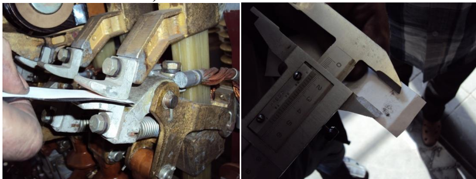
Рисунок 109 Проверить линии касания силовых контактов
