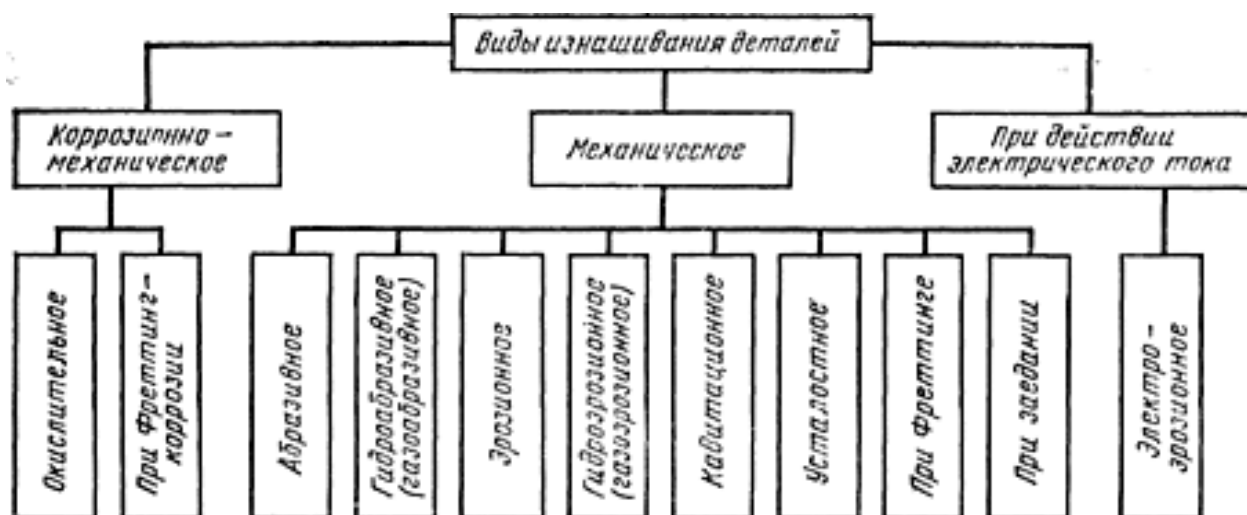
Рисунок 12. Классификация видов изнашивания деталей
