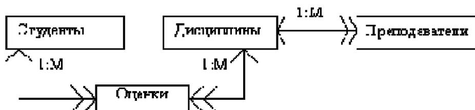
**Рис. 2.** Инфологическая модель реляционной базы данных
