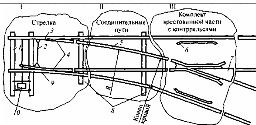
Рисунок 16 - Основные элементы одиночного обыкновенного стрелочного перевода: 1 — _____; 2 — _____
