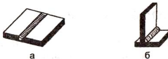
Рис. 40. Стыковой (а) и угловой (б) сварные швы
