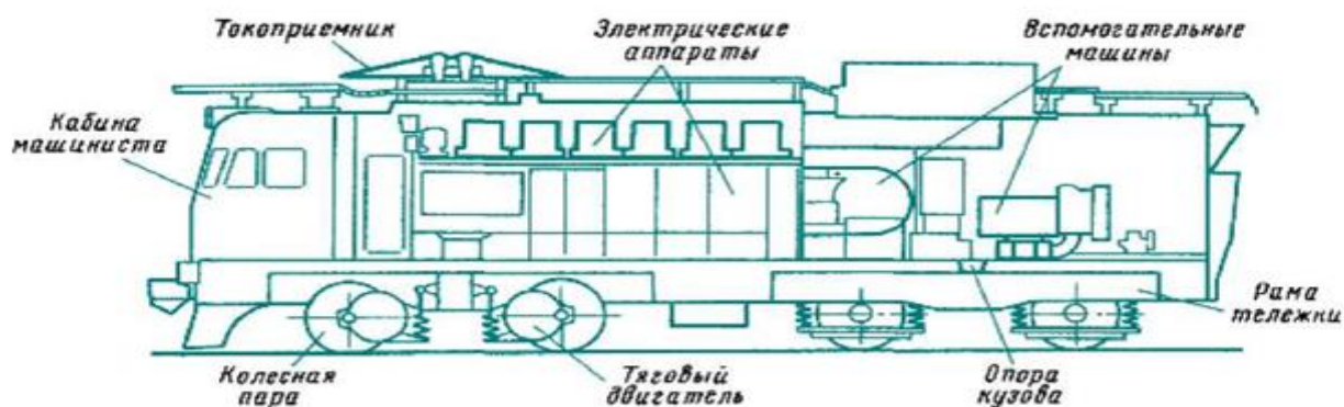
Рис. 1. Схематическое устройство электровоза
