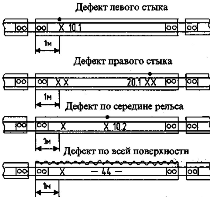
**Рис. 1. Схемы маркировки дефектных и острodefектных рельсов** Каталог содержит указания по эксплуатации, где характер дефекта считается дефектным (Д), острodefектным (ОД) или требующим усиленного наблюдe-
