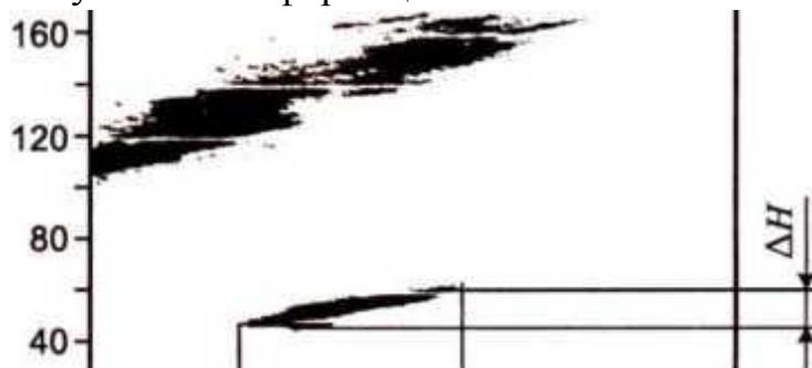
**Рис. 18.30. Измерение условных размеров дефекта по В-развертке**
