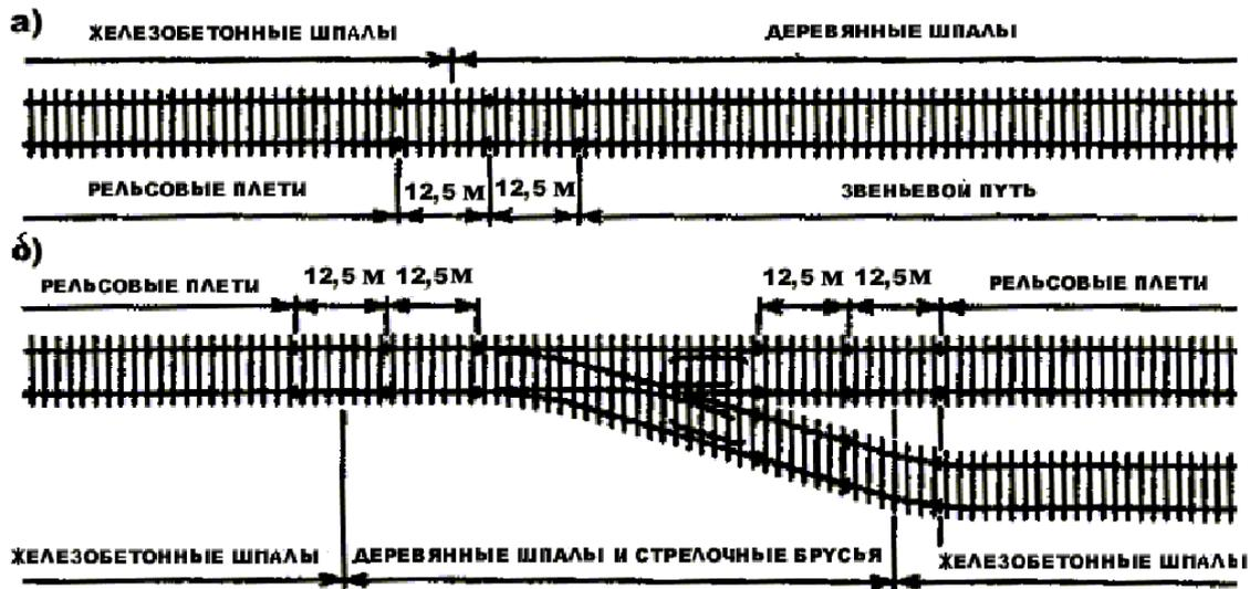
Рисунок 2.1 Схемы примыкания бесстыкового пути на железобетонных шпалах к звеньевому пути (а) и к стрелочному переводу (б)
