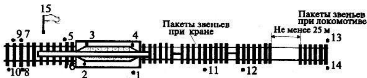
Рис.5. Схема расстановки рабочих при укладке звеньев путьекладчиком УК-25:
