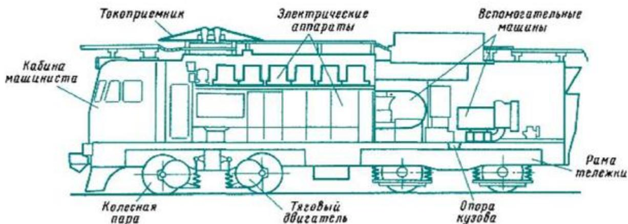
Рис. 1. Схематическое устройство электровоза
