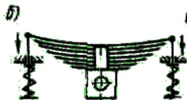
Рисунок 14- Рессорное подвешивание двойного типа
