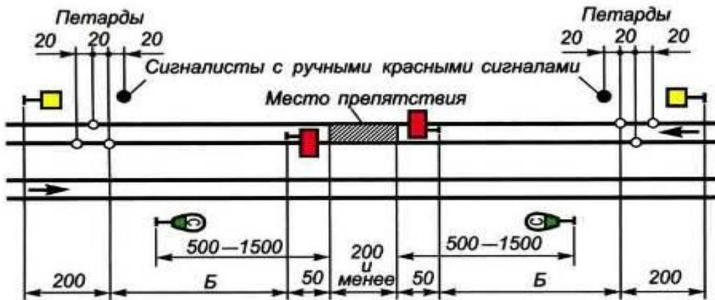
Рисунок 10-2 – Схема ограждения места производства работ на путях на двухпутном участке
