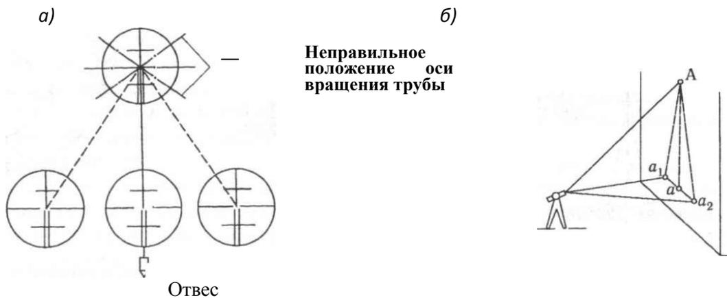
Рис. 12. Схема проверки горизонтальной оси вращения трубы:
