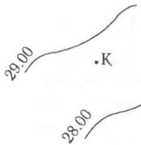
Рис. 4 Определение отметки точки по плану с горизонталями
