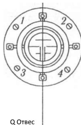
Рис. 13. Схема проверки положения сетки нитей зрительной трубы:
