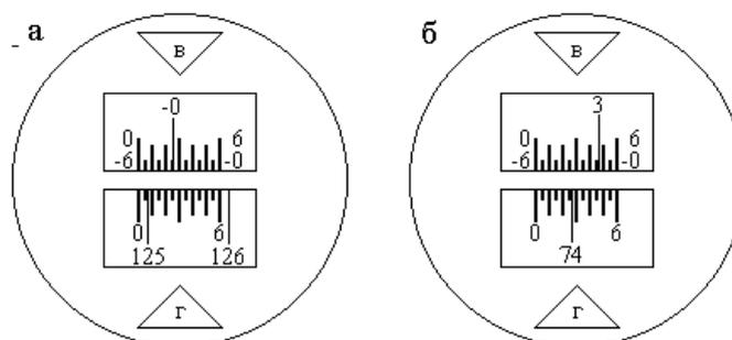
Рис. 7 Поле зрения отсчетного микроскопа теодолита 2Т30
