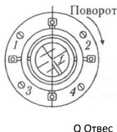
Рис. 14. Исправление положения сетки нитей
