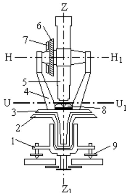
Рис. 9 Оси теодолита
