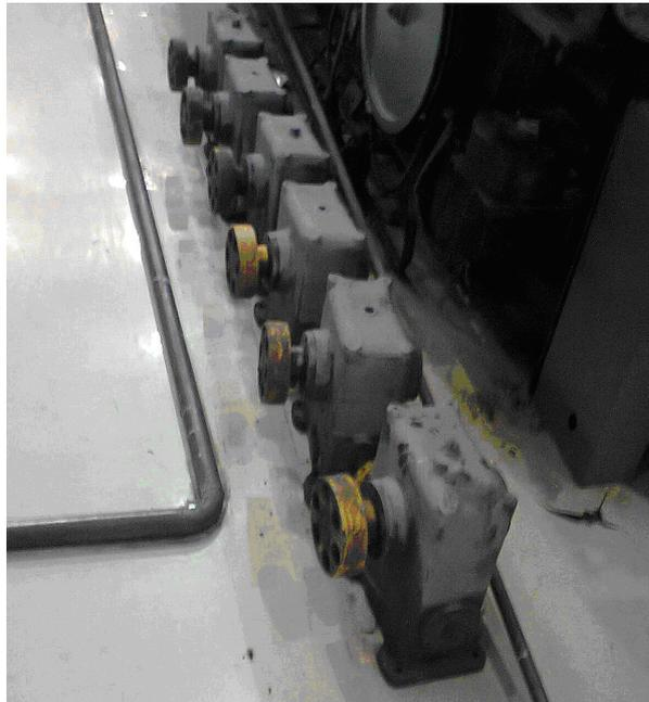
Рис. 5.6. Резервные редукторы привода вращения лонжеронов
