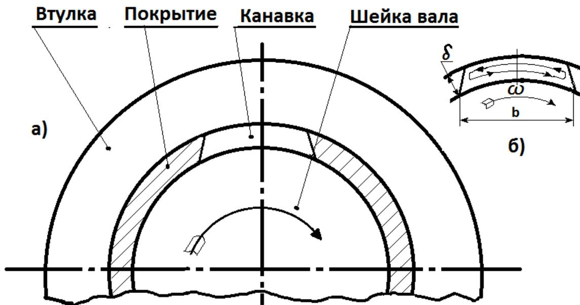
Рис. 2.1 Схема контактной зоны: а) подшипник, б) канавка
