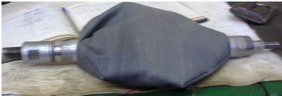
Рис. 5.4. Прижимной мешок, обеспечивающий рабочий контакт абразивной ленты к внутренней шлифуемой поверхности лонжерона
