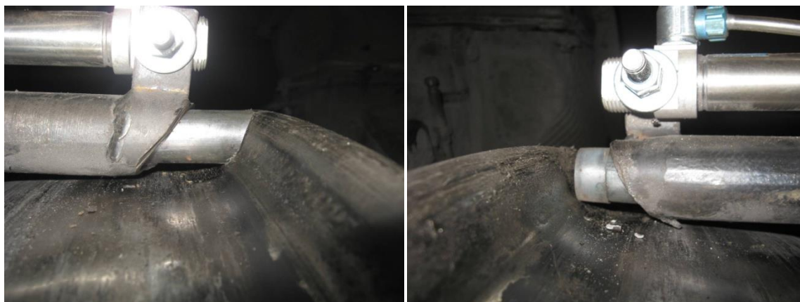
Рисунок 5.3 – Схема подвода смазочного стержня к гребню колеса
