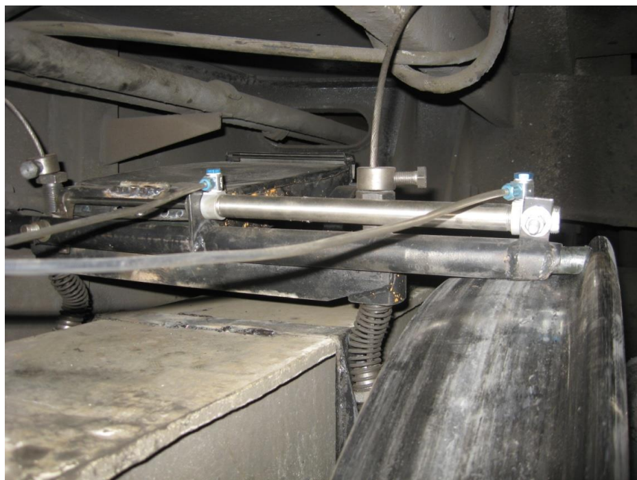
Рисунок 5.5 – Общий вид конструкции АГРС с пневмоприводом
