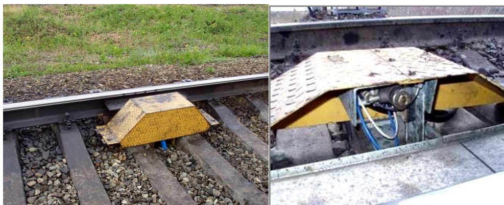
Рисунок 1.3 – Стационарный рельсосмазыватель СПР-02
