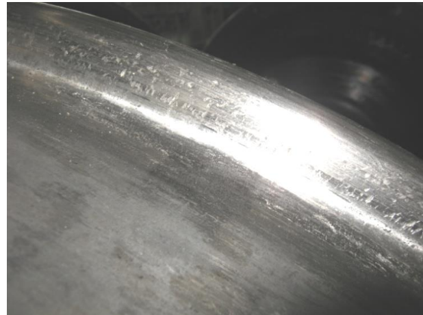
Смазочный материал Forsan Industrial на гребне колеса (визуальный контроль)
