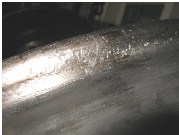
Смазочный материал РАПС-2 на гребне колеса (визуальный контроль)
