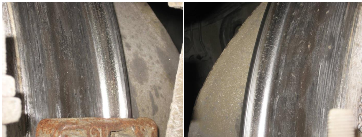
Рисунок 5.4– Смазочный материал на гребне колеса электровоза
