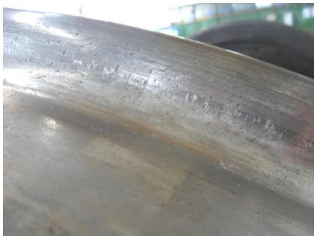
Смазочный материал Forsan Industrial на гребне колеса (визуальный контроль)
