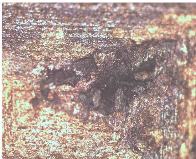
Рисунок 4.7 Вид изношенной поверхности индентора из кермета TiC–ЖС6У с покрытием Zr-Ti-N-C при контактировании с образцами из кермета TiC – ЖС6У с покрытием Zr-Ti-N-C, \times 20
