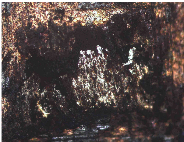
Рисунок 4.5 Вид изношенной поверхности индентора из кермета TiC–ЖС6У при контактировании с образцами из сплава ЖС6У, \times 20
