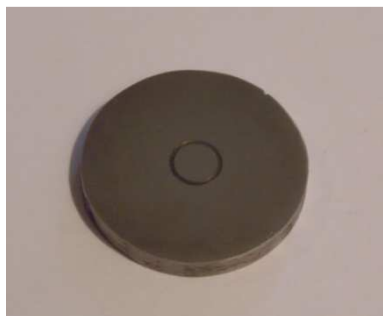
Рисунок 2.5 Образец ЖС6У после испытания на износ
