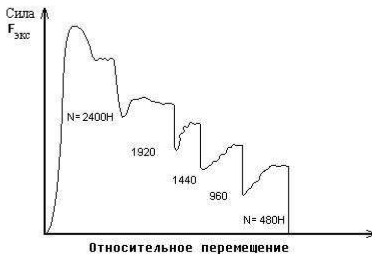
Рисунок 2.19 Типичная запись тангенциальной силы адгезионного взаимодействия при использовании метода уменьшающихся нагрузок
