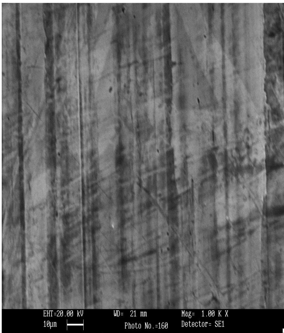
Рисунок 4.13 Вид зоны трения колодки из сплава Л63 в режиме вторичных электронов, изношенной в глицерине на пути трения 350 м (x1000)
