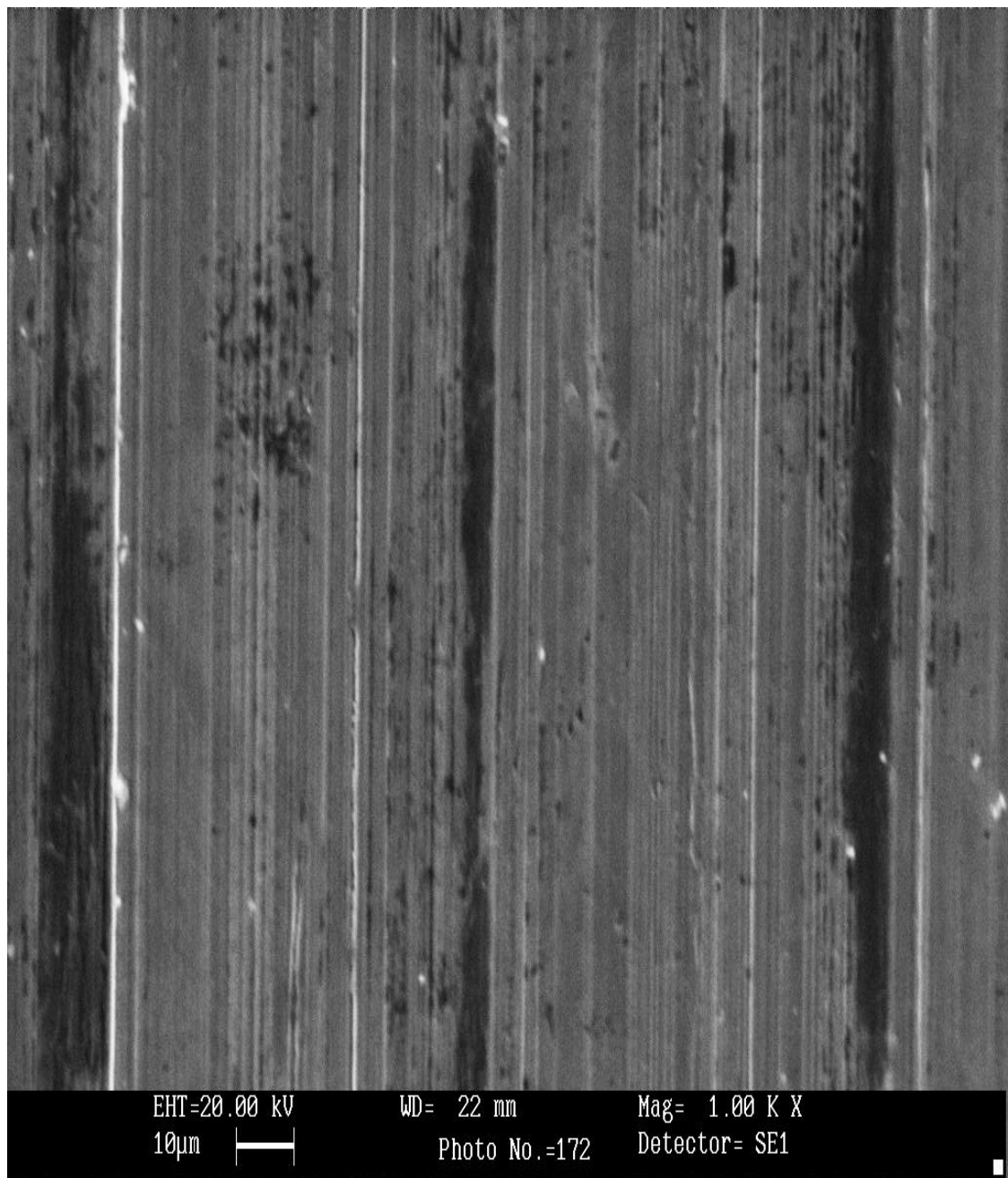
Рисунок 4.33 - Вид зоны трения стального ролика в режиме вторичных электронов, изношенного в глицерине на пути трения 700 м (x1000)
