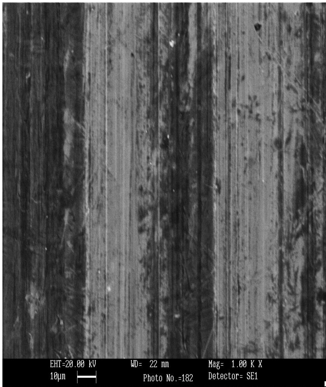
Рисунок 4.34 Вид зоны трения стального образца в режиме вторичных электронов, изношенного в глицерине на пути трения 1400 м (x1000)
