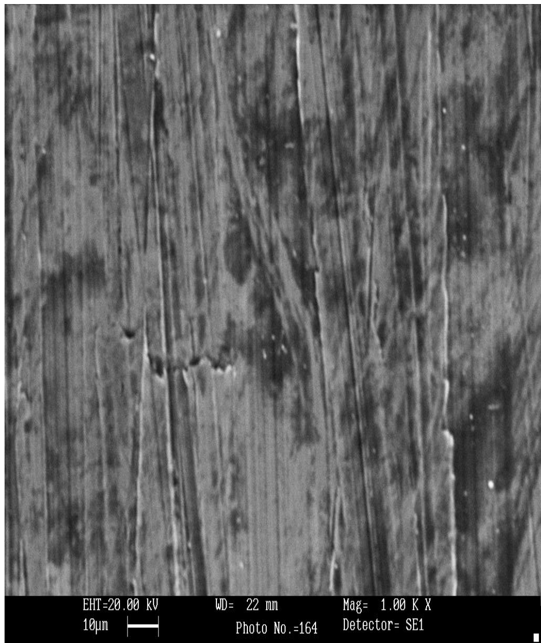
Рисунок 4.32 Вид зоны трения стального ролика в режиме вторичных электронов, изношенного в паре с медным сплавом на пути трения 350 м (x1000)
