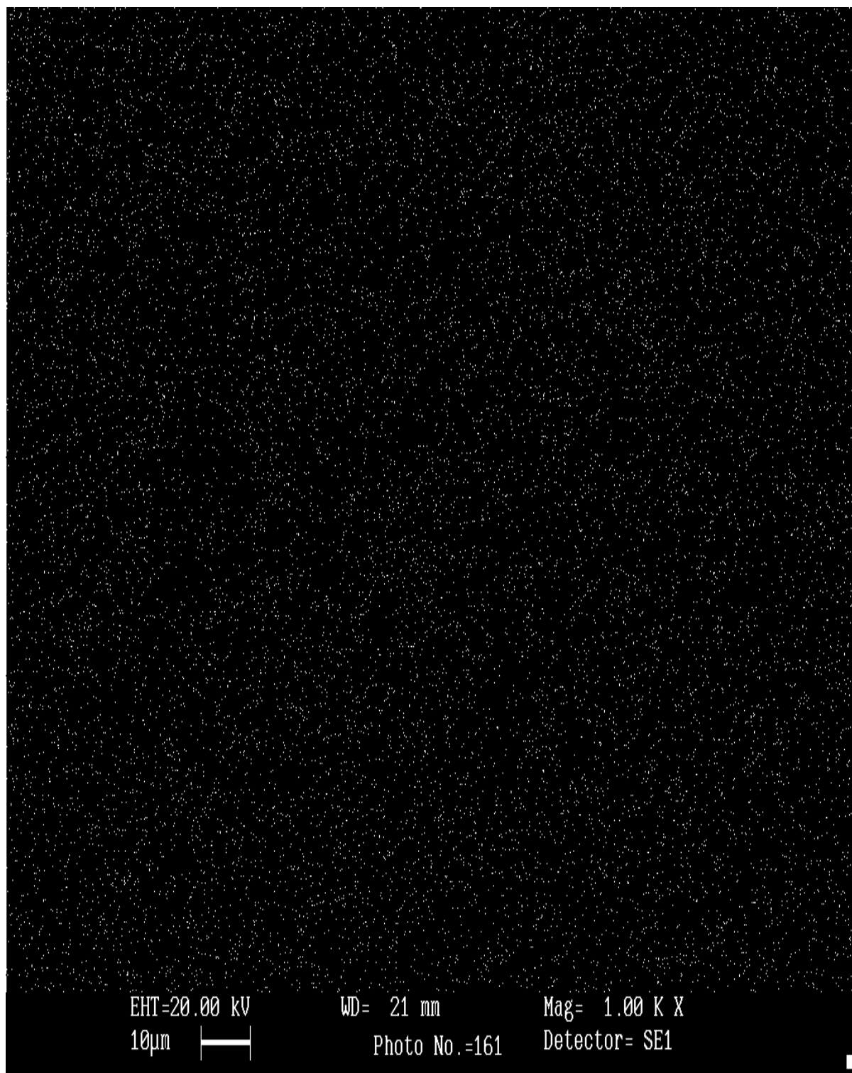
Рисунок 4.19 Рентгеноспектральное распределение меди в зоне трения образца из сплава Л-63, изношенного в глицерине на пути трения 350 м (x 1000)
