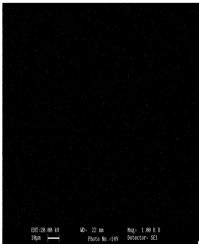
Рисунок 4.37 - Рентгеноспектральное распределение хрома в зоне трения стального образца, работавшего в глицерине (x1000), путь трения 70 м
