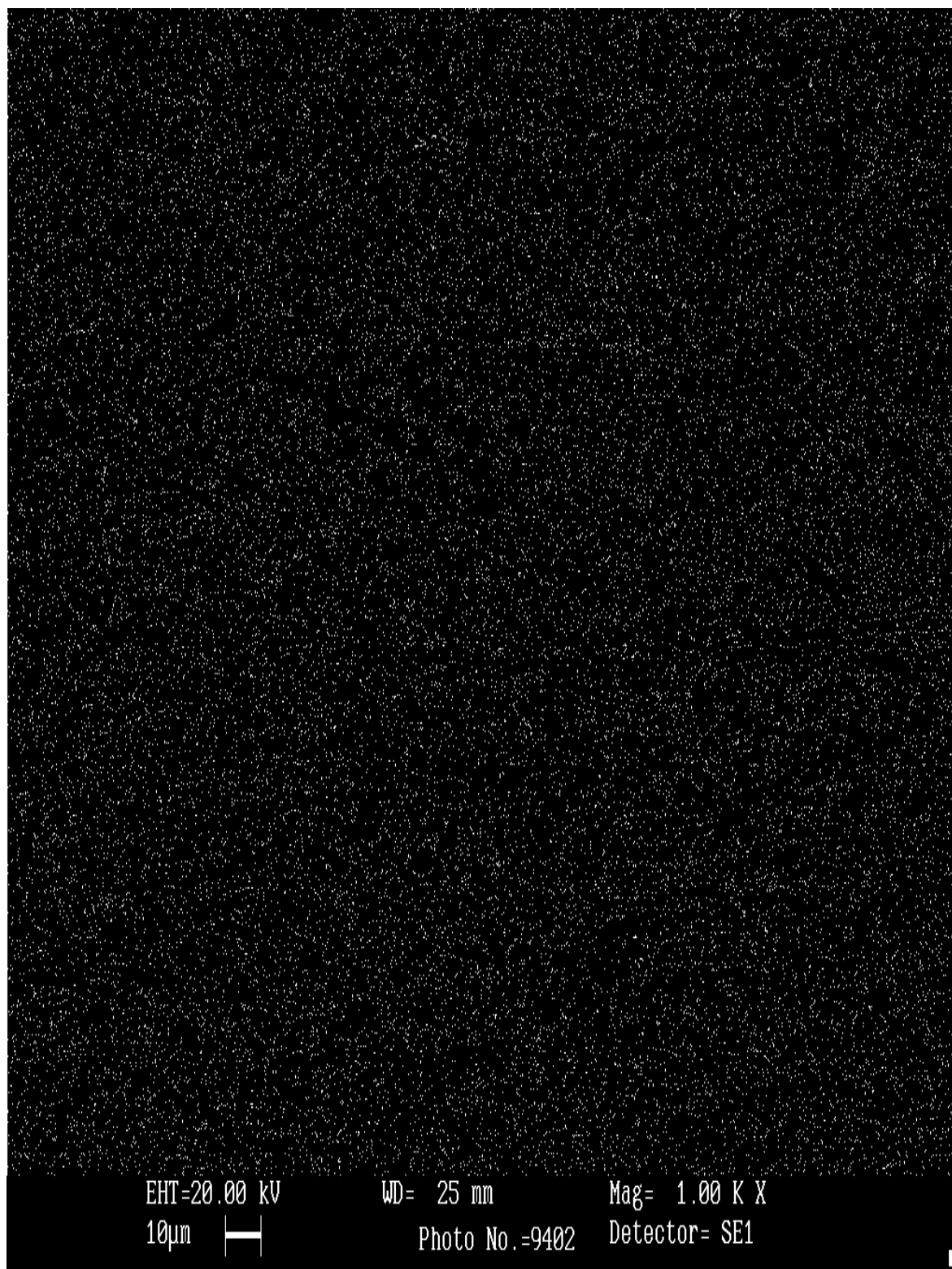
Рисунок 4.55 Рентгеноспектральное распределение меди в темной пленке в зоне трения латуни (x1000)
