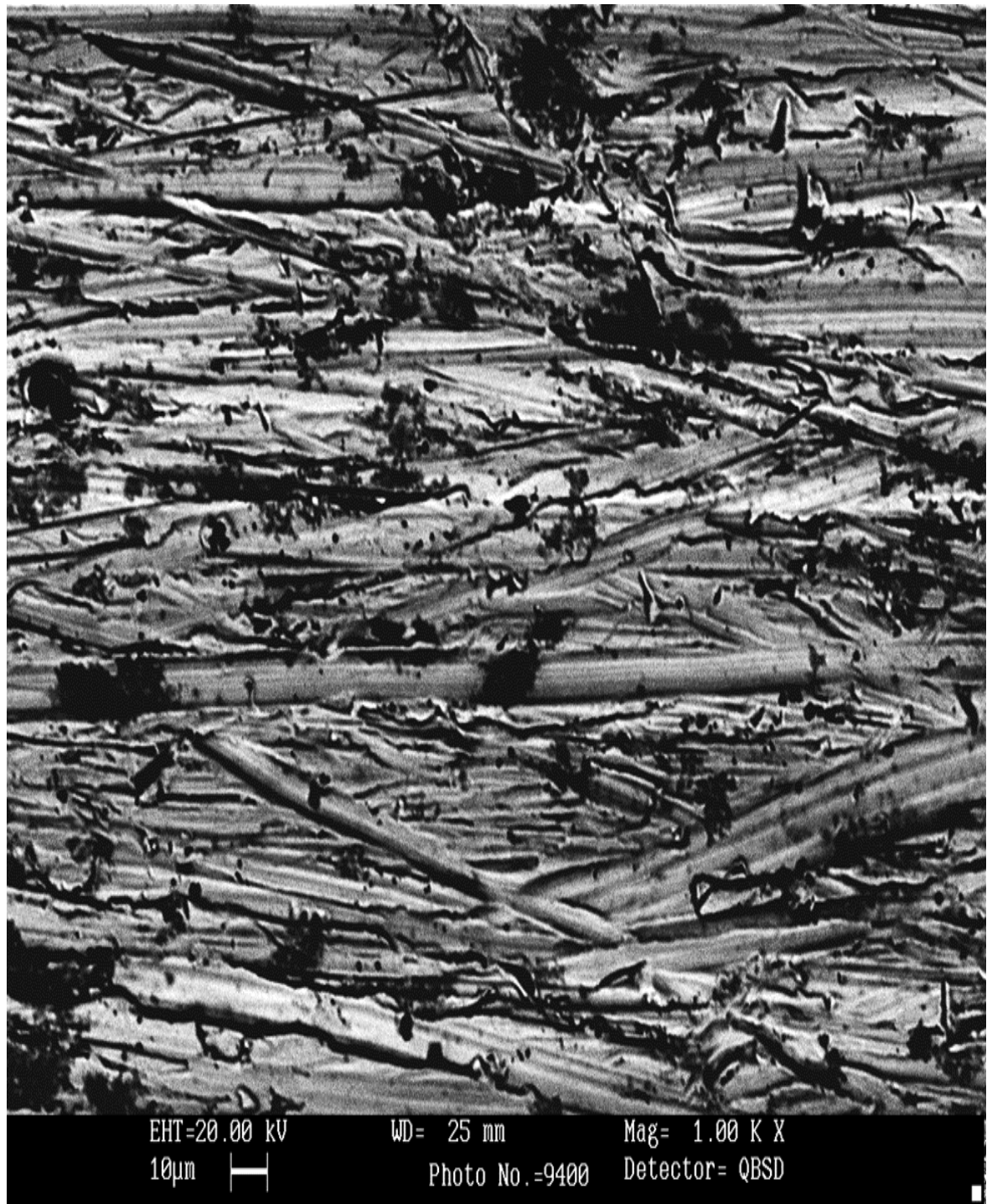
Рисунок 4.53 Вид темной пленки в зоне трения латуни в упруго отраженных электронах после изнашивания на пути трения 2100 м (x1000)
