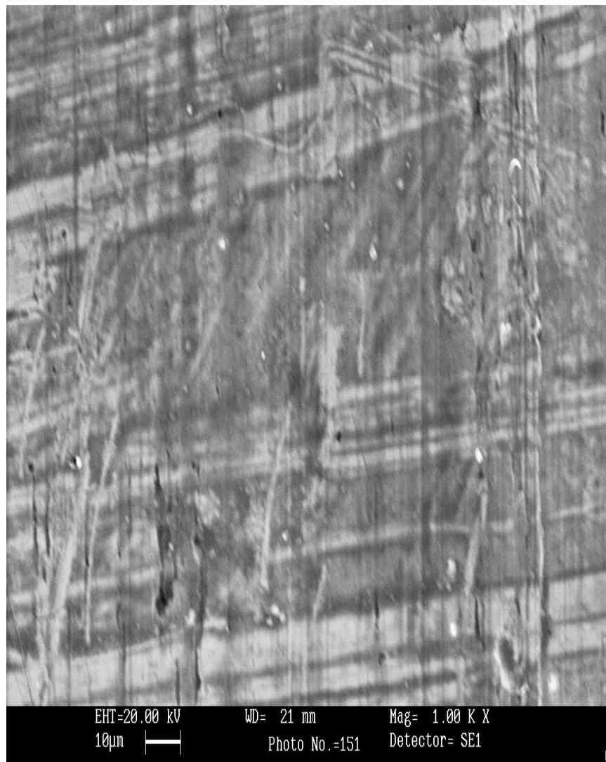
Рисунок 4.12 Вид зоны трения медного сплава, изношенного в глицерине со стальным роликом на пути трения 210 м (x1000)
