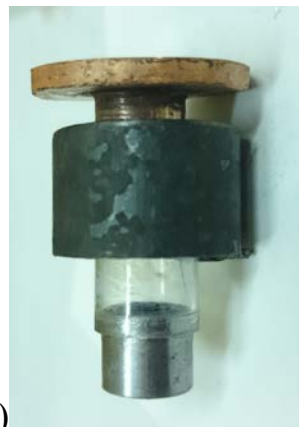
Рисунок 3.1. Конструктивное исполнение приспособления для изготовления опытных образцов: а) пуансон, б) втулка стальная, в) втулка стеклянная, г) приспособление для спекания в сборе.
