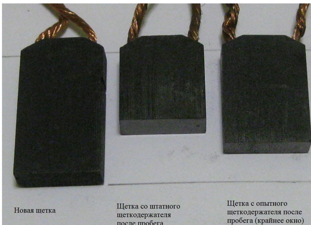
Рисунок 4.3. Новая щетка, щетка штатного щеткодержателя и щетка с крайнего окна опытного щеткодержателя после испытаний
