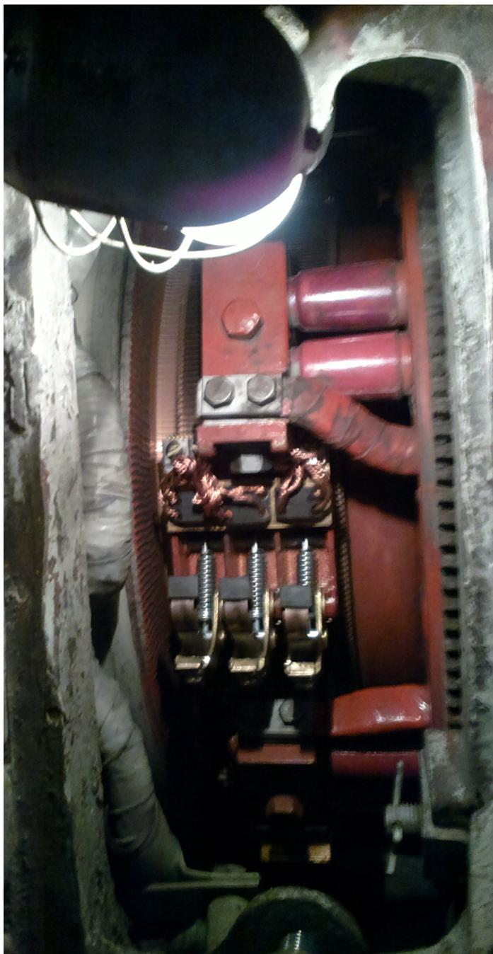
Рисунок 4.2. Щеткодержатель смонтирован на электровозе ВЛ80с №1676
