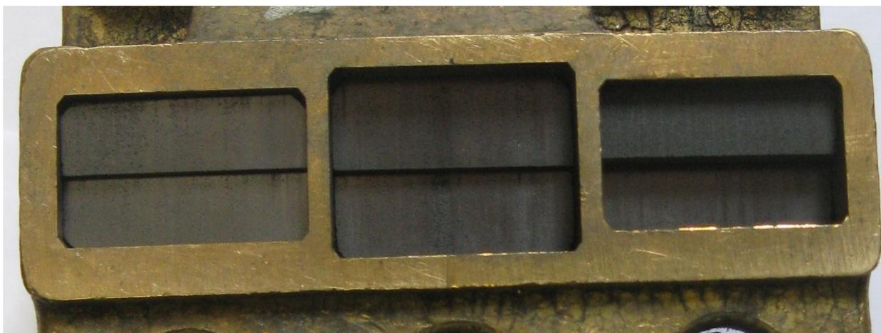
Рисунок 3.1. Окна опытного щеткодержателя: среднее окно выполнено как у штатного щеткодержателя, а крайние окна более узкие на 5 мм.
