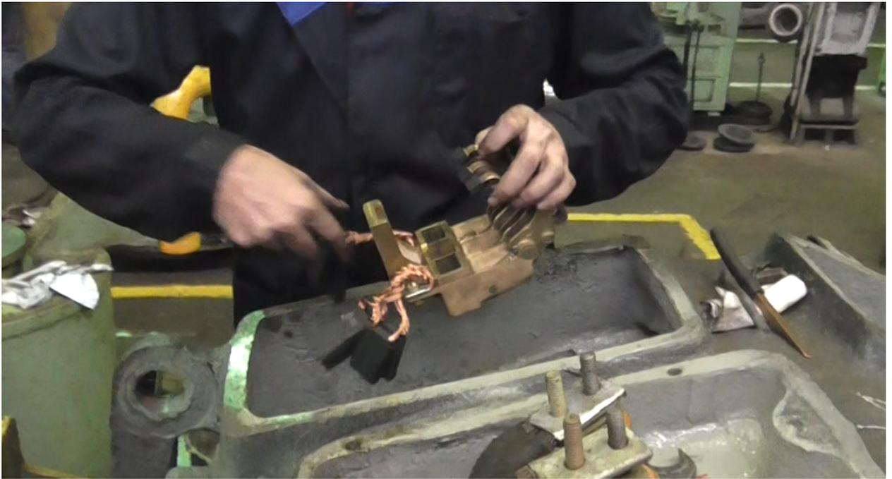
Рисунок П2. Монтаж опытного щеткодержателя
