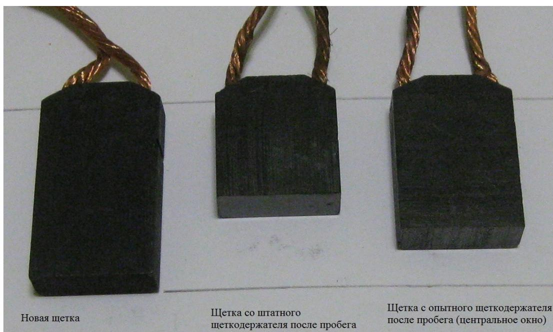
Рисунок 4.4. Новая щетка, щетка штатного щеткодержателя и щетка с центрального окна опытного щеткодержателя после испытаний
