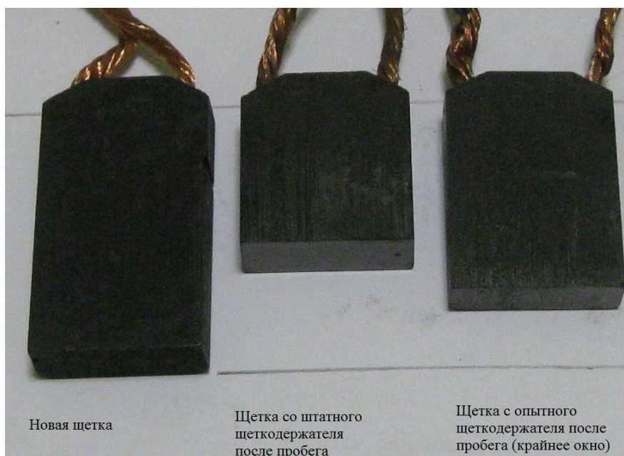
Рисунок 9. Новая щетка, щетка штатного щеткодержателя и щетка с крайнего окна опытного щеткодержателя после эксплуатационных испытаний
