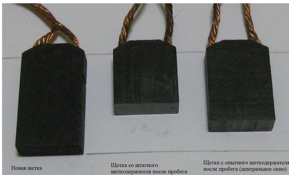
Рисунок 10. Новая щетка, щетка штатного щеткодержателя и щетка с центрального окна опытного щеткодержателя после эксплуатационных испытаний
