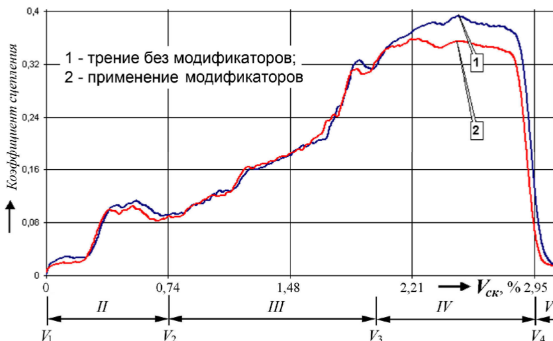
Рисунок 3.3 – Кривые изменения коэффициента сцепления во времени как функции скорости относительного скольжения: II – «трогание» ПС; III – реализация тягового усилия локомотива; IV – граница устойчивости реализации тягового усилия; V – потеря устойчивости тягового усилия, снижение коэффициента сцепления, наступление режима боксования
