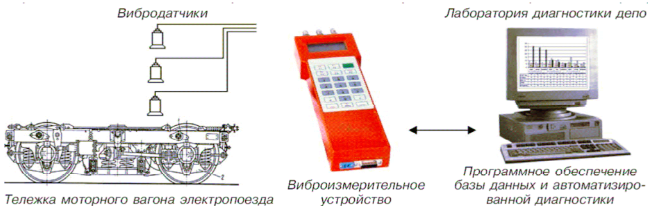
Рисунок 1.2 – Типовая структурная схема вибродиагностического комплекса, применяемого для диагностики колёсно-рельсовых блоков электропоездов
