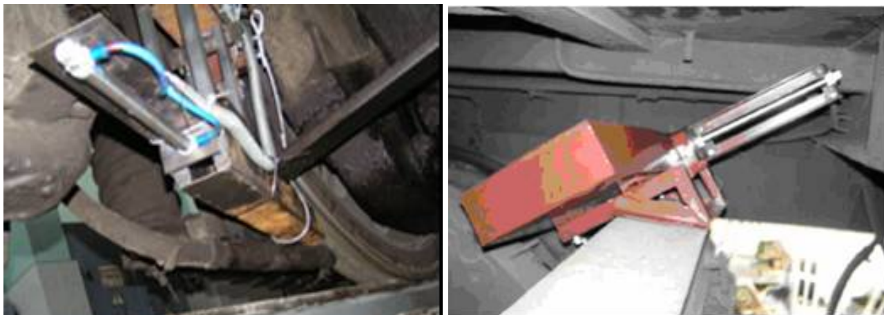
Рисунок 4.8 – Конструкции модификации поверхностей трения железнодорожных колёс: а – СМПТ-01; б – СМПТ-02
