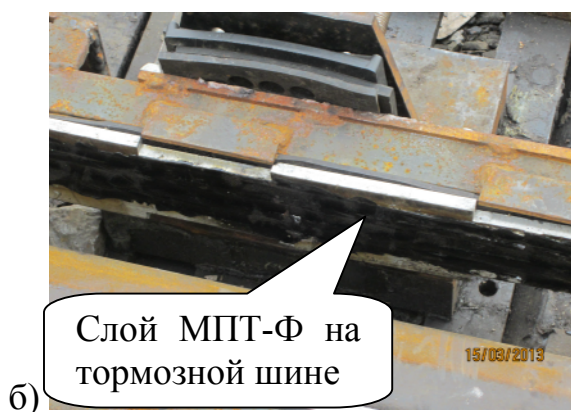
Рисунок 4.21 – Устройство шумоподавления при роспуске товарных вагонов на механизированных сортировочных горках: а – кинематическая схема; б – тормозная шина с модификатором МПТ-Ф; в – слой МПТ-Ф на колёсной паре после её взаимодействия с тормозной шиной
