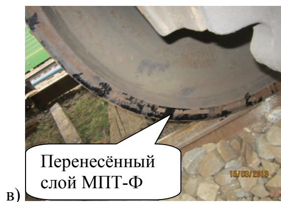
Рисунок 4.21 – Устройство шумоподавления при роспуске товарных вагонов на механизированных сортировочных горках: а – кинематическая схема; б – тормозная шина с модификатором МПТ-Ф; в – слой МПТ-Ф на колёсной паре после её взаимодействия с тормозной шиной
