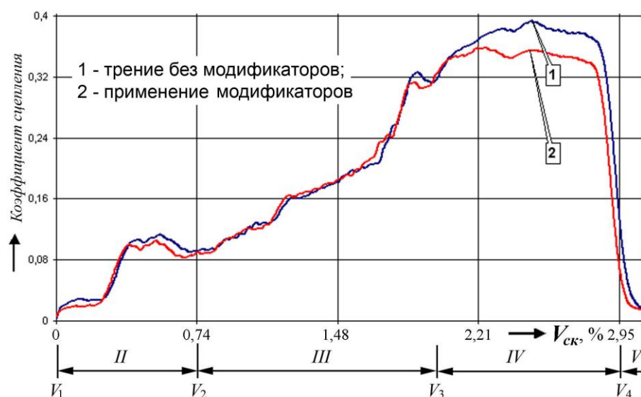
Рис. 7 – Кривые изменения коэффициента сцепления во времени как функции скорости относительного скольжения: II – «трогание» подвижного состава; III – реализация тягового усилия локомотива; IV – граница устойчивости реализации тягового усилия; V – потеря устойчивости тягового усилия, снижение коэффициента сцепления, наступление боксования
