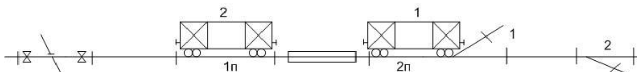
Рисунок 3.7 – Ситуация скатывания отцепов в зоне 1 ТП
