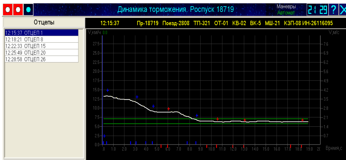
Рисунок 3.1 – Графическая иллюстрация плавного торможения отцепов
