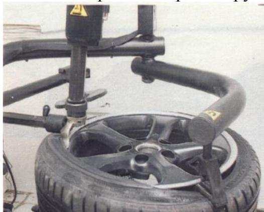
Рис. 18. Применение манипулятора «третья рука» и ролика на дополнительном рычаге
