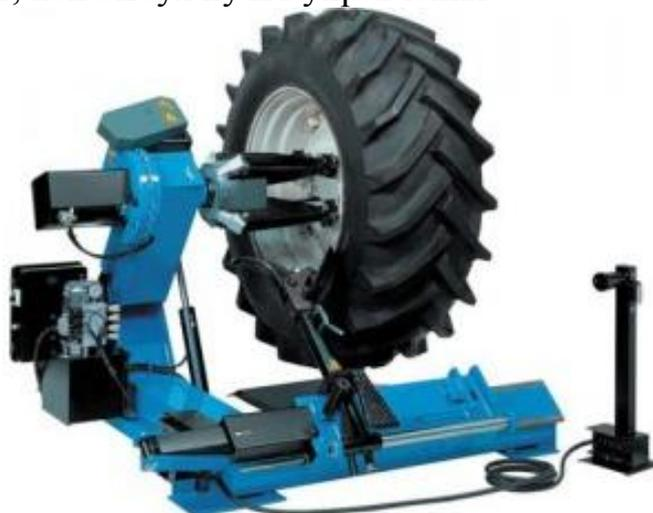
Рис. 19. Шиномонтажный станок для грузовых автомобилей
